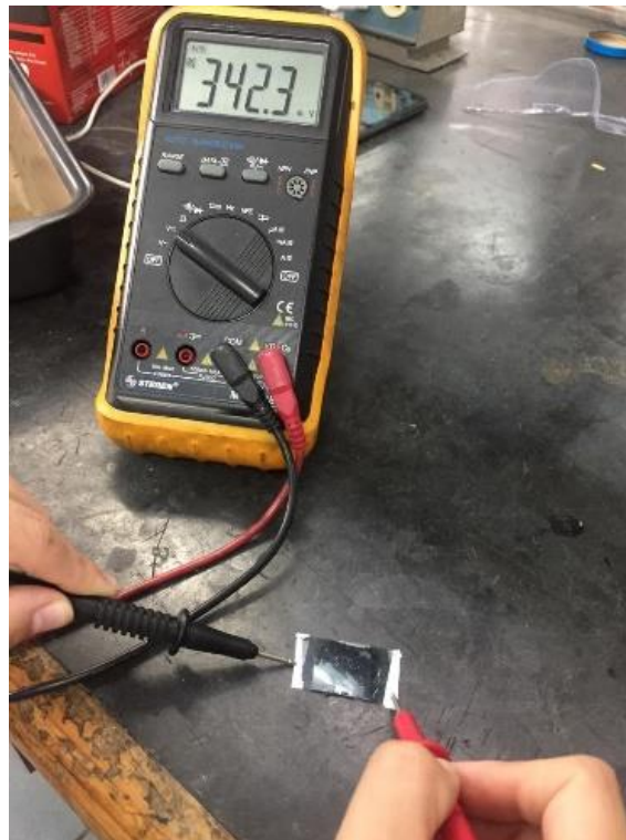
Figura 7. Toma de resistencia de la batería con multímetro.
