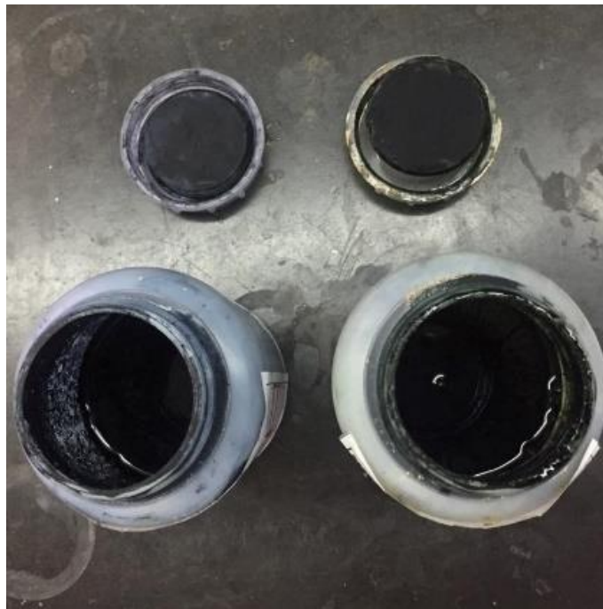
Figura 2. Muestra de tintas PEDOT: PIAM, PANI: PIAM.
