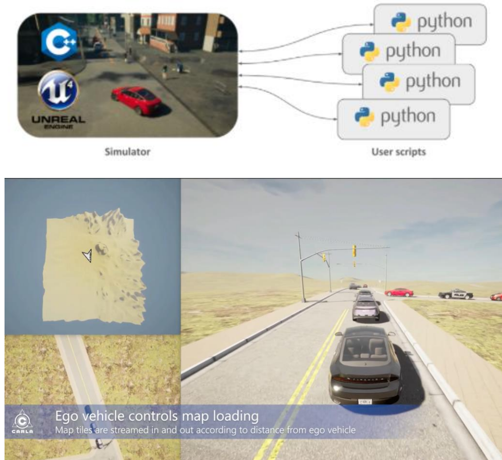
Figura 3.4.5. Superior: estructura de funcionamiento de CARLA. Inferior: Ejemplo de simulación del simulador CARLA mostrando la carga del mapa utilizado. [49]
