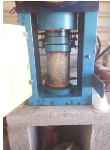
Figura 10. Prueba de compresión. Fuente propia.
