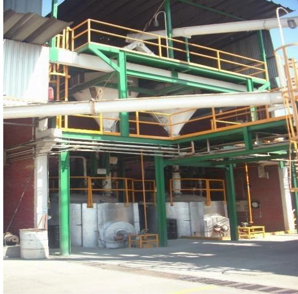
**Figura 3.5** Proceso de pirolisis para depolimerizar el PMMA. (*Planta actual en el Estado de México*).
