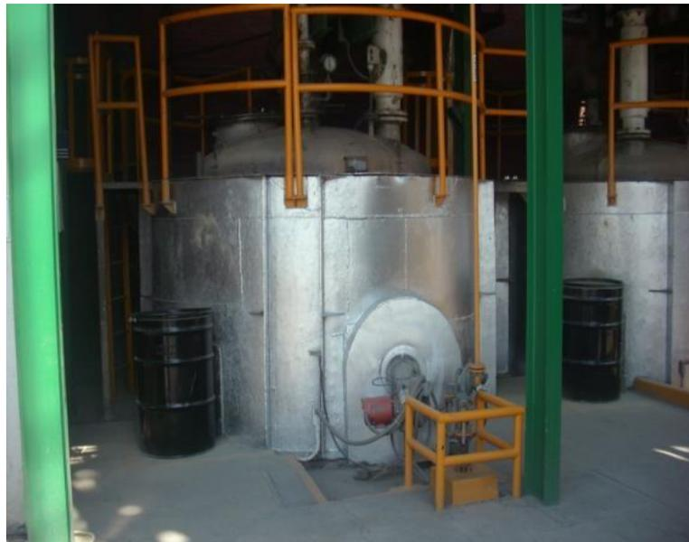
**Figura 3.6** Tanque de almacenamiento de RMMA (*Planta actual en el Estado de México*).
