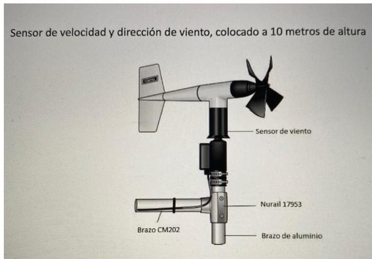
**Figura 4.9c** *Sensor de velocidad y dirección de viento.* Manual de instalación equipo AWS (2014) SENEAM.
