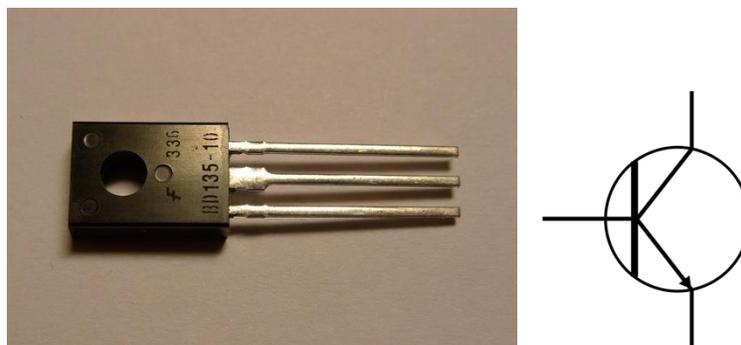
**Fig. 2.2m** Transistor (2021). Licencia libre de uso: <https://pixabay.com/es/photos/transistor-bd-electr%C3%B3nico-hardware-903642/>
