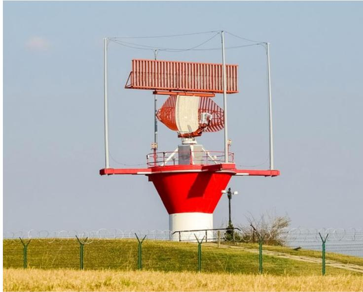
**Figura 4.7.** Radar primario y secundario (2020), foto extraída de <https://pixabay.com/es/photos/radar-estaci%C3%B3n-de-radar-cielo-4777615/> Licencia libre de uso.
