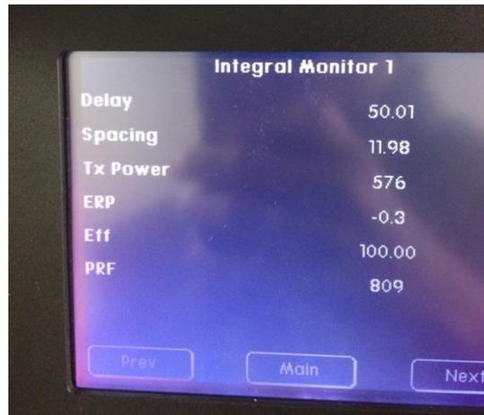
**Figura 4.6a.** Foto: *verificación de parámetros del DME*. Elaboración propia Núñez A. (2021).
