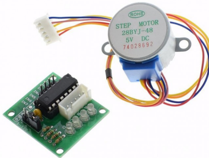
Figura 3.3: Motor 28BYJ-48 con módulo controlador ULN2003.
