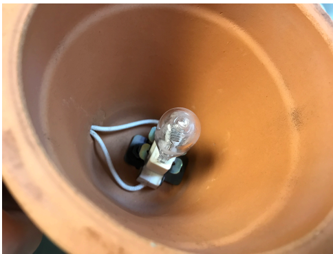
Fig. 2.13: Lámpara de halógeno que irradia el calor utilizado para calentar la muestra.
