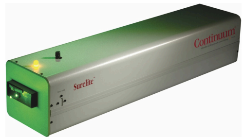
Fig. 2.2: Láser Continuum Surelite III, Nd:YAG utilizado en el proceso experimental [54].
