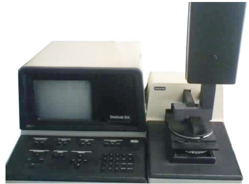
Fig. 2.14: Perfilómetro marca Veeco modelo Dektak IIA , utilizado para el estudio de los cráteres de ablación [61].
