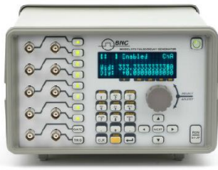
Fig. 2.3: Generador de retrasos Berkeley Nucleonics Model 575 utilizado en el proceso experimental [55].
