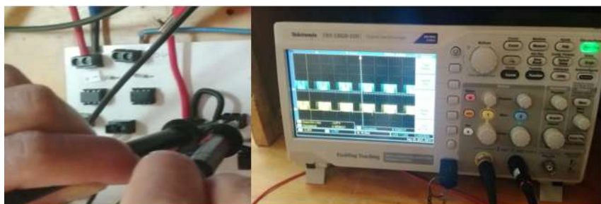
Figura 60. Testeo etapa de aislamiento óptico. Fuente Propia
