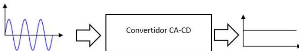
Figura 2. Estructura básica de convertidor CA-CD. Fuente Propia
