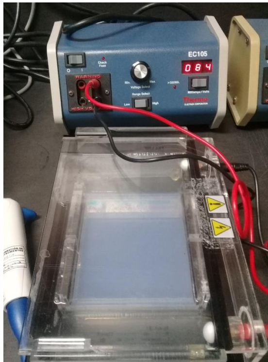
Imagen 11. Cámara de electroforesis trabajando a 84 volts.
