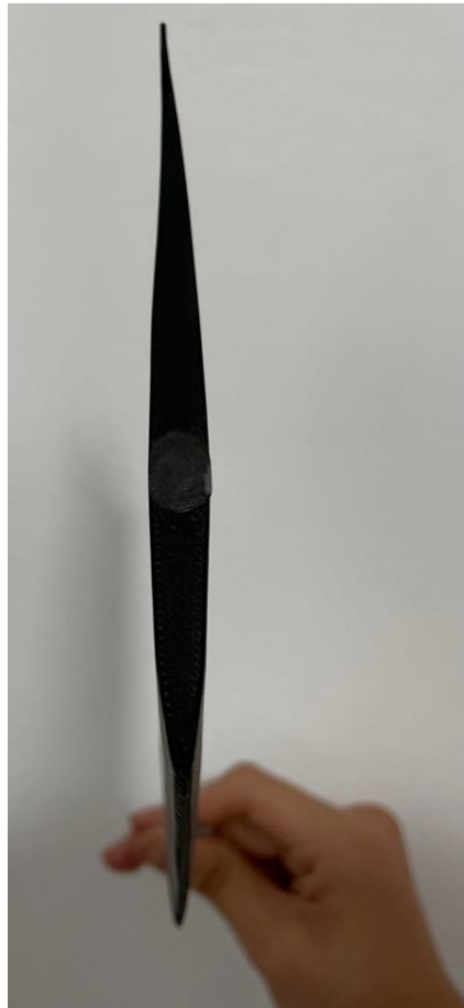
Figura 16. Perfil NACA 0006 impreso en 3D.
