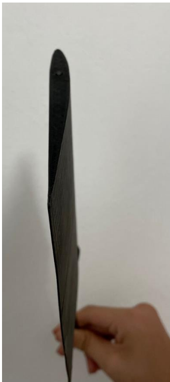
Figura 18. Perfil NACA 2408 impreso en 3D.
