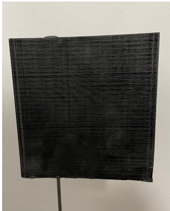
Figura 20. Perfil NACA 6409 impreso en 3D.
