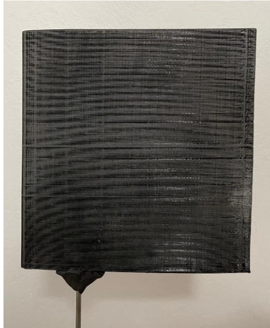
Figura 17. Perfil NACA 2408 impreso en 3D.
