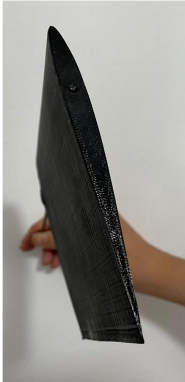
Figura 19. Perfil NACA 2408 impreso en 3D.
