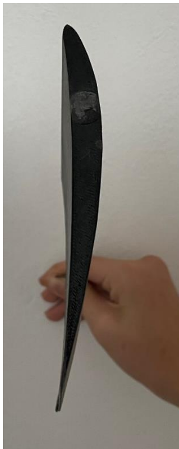
Figura 22. Perfil NACA 6409 impreso en 3D.
