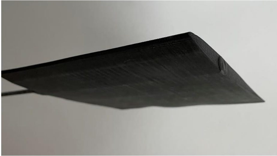
Figura 15. Perfil NACA 0006 impreso en 3D.
