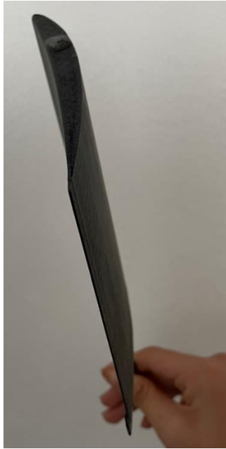
Figura 21. Perfil NACA 6409 impreso en 3D.
