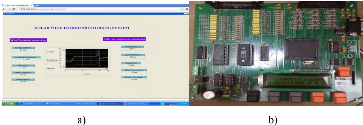
Figura 48 a) Interfaz HMI. b) Hardware del sistema datalogger [78].
