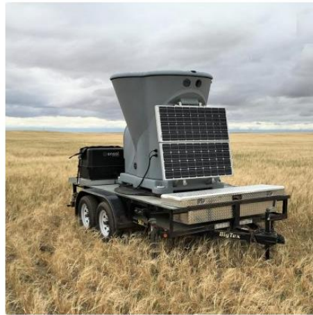
Figura 40 sistema SODAR Triton en ubicación remota [10].
