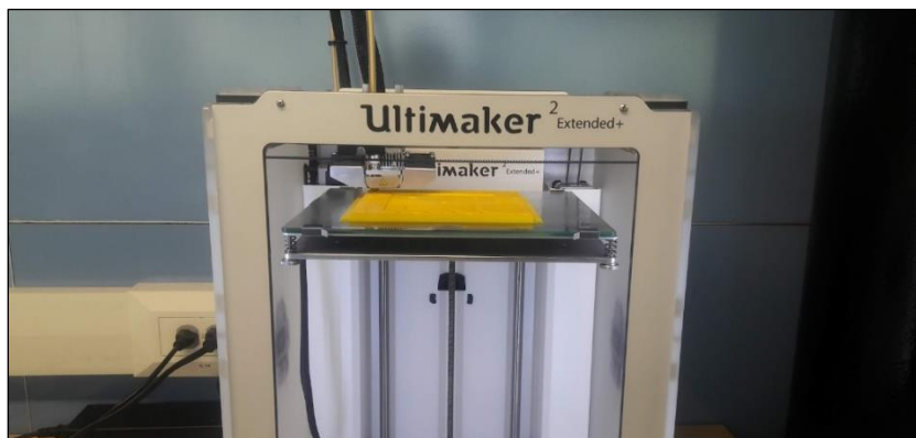
Figura 41. Placa terminal impresa en 3D.
