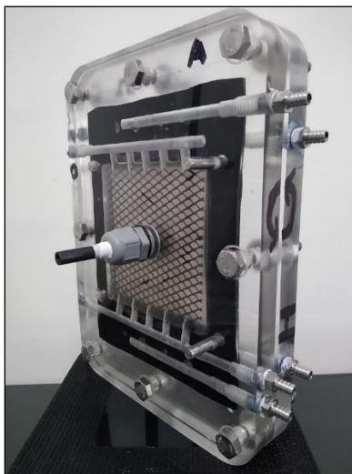
Figura 45. Diseño validado de placas terminales.
