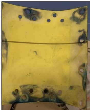
Figura 32. Membrana aniónica contaminada por fugas internas en el sistema.
