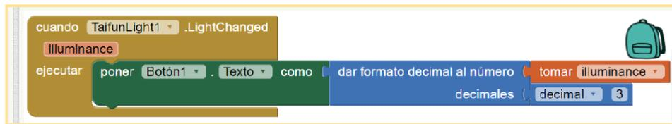
**Figura 6. Primer módulo de bloques “illuminance”.** Este bloque permite el control del ALS (Ambient Light Sensor) del dispositivo móvil para que pueda captar una señal de luz e interpretarla como transmitancia de la luz a través de la muestra (lux) vs tiempo (h).
