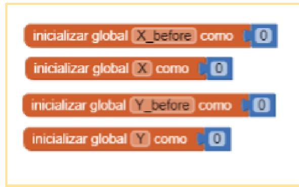
**Figura 8. Tercer módulo de bloques. Definición de las variables para diseño de la gráfica.** El eje Y representa la transmitancia de la luz a través de la muestra (lux), mientras que el eje X representa el tiempo (h). Las variables “X y Y anteriores” representan el cero para ambas variables.
