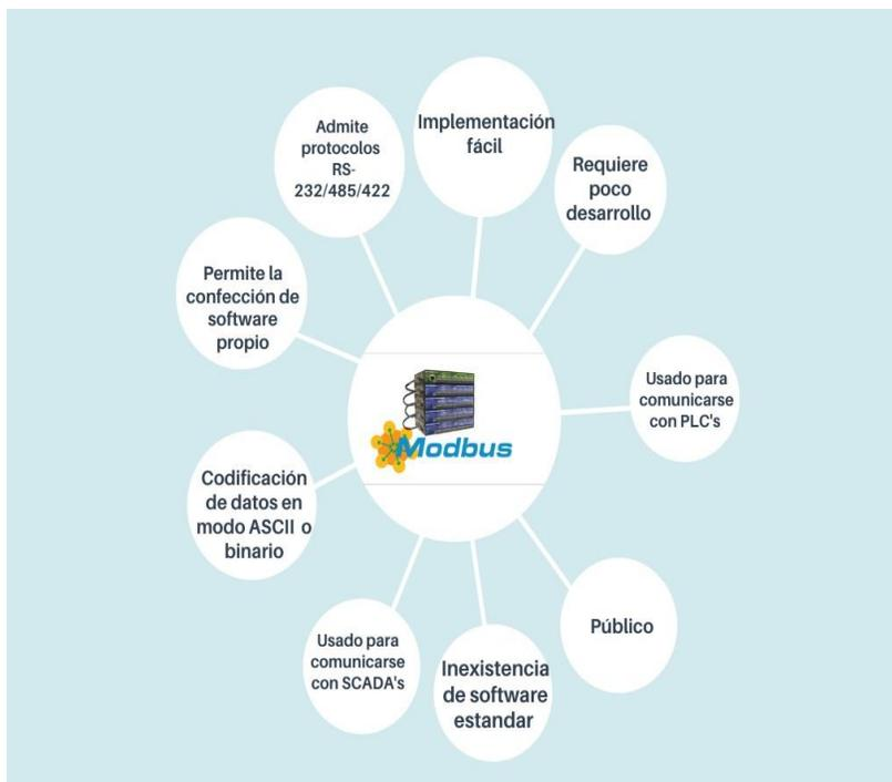
Figura 4.16: Características del protocolo MODBUS
