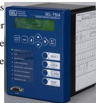
Los medios de comunicación con los que cuenta son; puertos ethernet unitarios o duales, conectores multimodo ST serial o de fibra óptica y EIA-232 serial.
