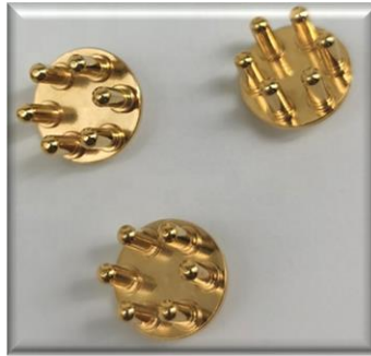
Fig. 5.14: Electrodo seco en forma de tentáculo fabricados en cobre y chapa de oro [99]
