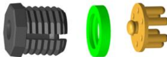
Fig. 6.2: Piezas del subsistema para la colocación de los electrodos en el casco en el siguiente orden: tornillo, anillo electrodo.
