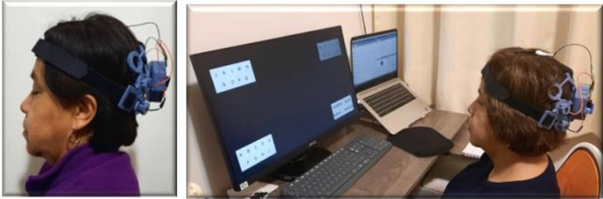
Fig. 6.12: A la izquierda sujeto de prueba con el sistema de adquisición montado, a la derecha etapa de adquisición de las señales.
