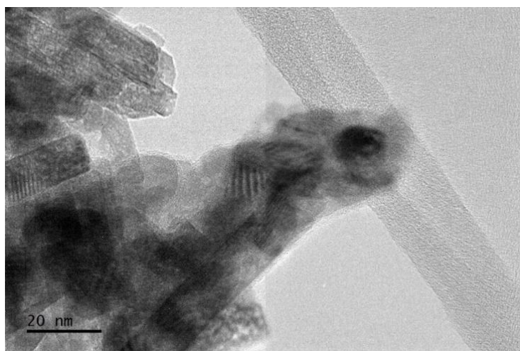
Figura 3.11. Imagen típica por microscopia TEM del catalizador soportado calcinado Cu/Ce-r.
