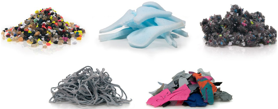
Nike Grind. Gránulos de caucho, EVA, fibras, pieles y textiles para formar nuevos productos o accesorios
