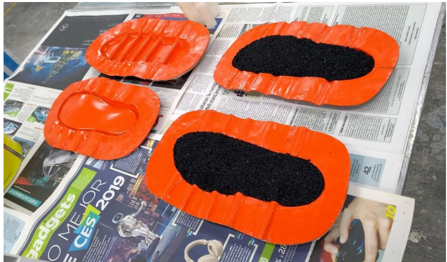
Prueba b. La pieza no se unió porque las partículas no fueron mezcladas correctamente con la resina.
