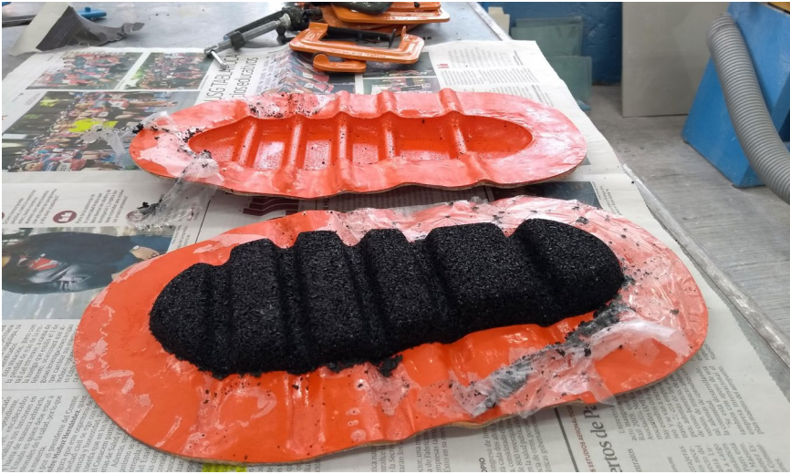
Prueba 2. Después de abrir el molde, salió una pieza muy flexible húmeda pero completa con algunos huecos
