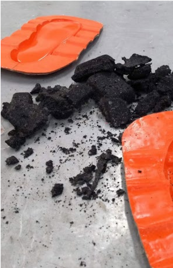
Prueba b. La pieza no se unió porque las partículas no fueron mezcladas correctamente con la resina.
