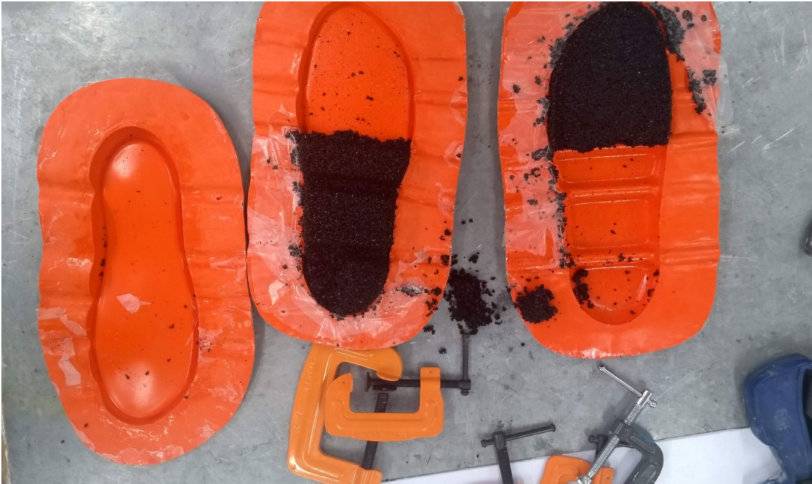
Prueba 3. Al desmoldar, la pieza se partió y desmoronó, además de salir húmeda
