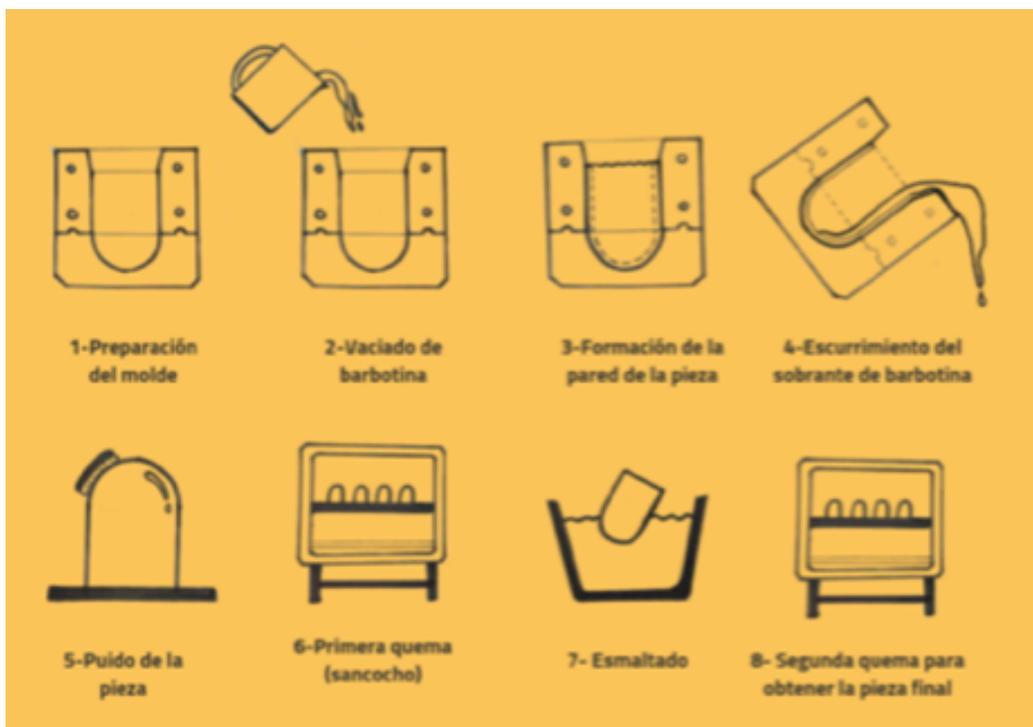
Figura 62. Esquema de proceso de vaciado. Fuente: Propia
