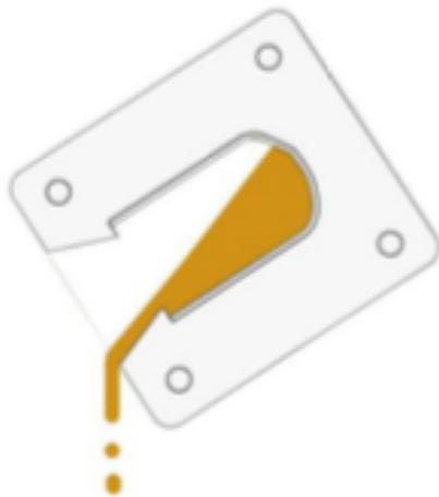
Se retira el exceso de barbotina y se forma la pared de la pieza final.
