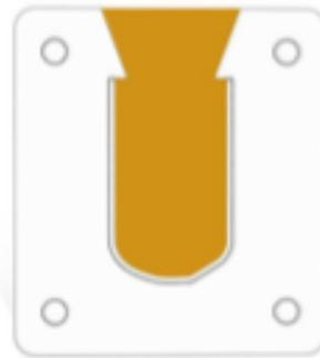
Al vaciar la barbotina se queda dentro del molde hasta que forma una pared de 0.4mm a 0.5 mm
