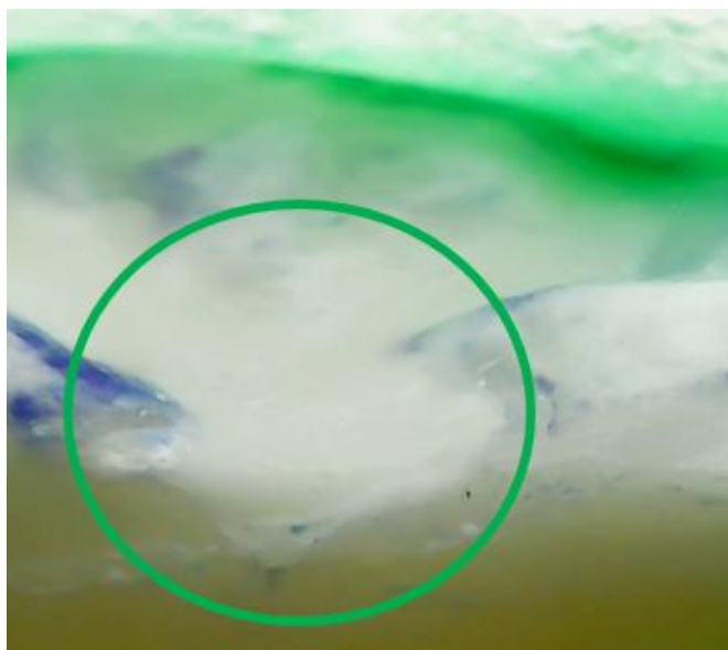
Figura 14. Grupo verde fisura en U sin presencia de en el sellador
