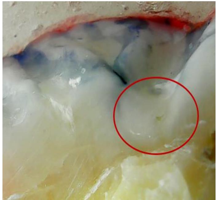
Figura 11. Grupo rojo fisura V con presencia de burbuja en el sellador
