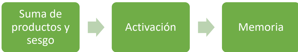
Figura 29. Etapas de una capa totalmente conectada. Fuente: Elaboración propia.
