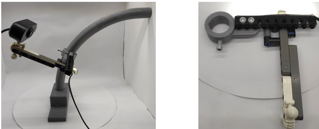
Figura 12. Lado izquierdo, base y arco, lado derecho, abrazadera y acople para la cámara y en la parte inferior. Fuente: Elaboración propia.
