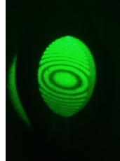
Figura 3.2: Haz de luz en forma de cono elíptico después de viajar por el interferómetro e interferir en una pantalla forma este patrón de interferencia
