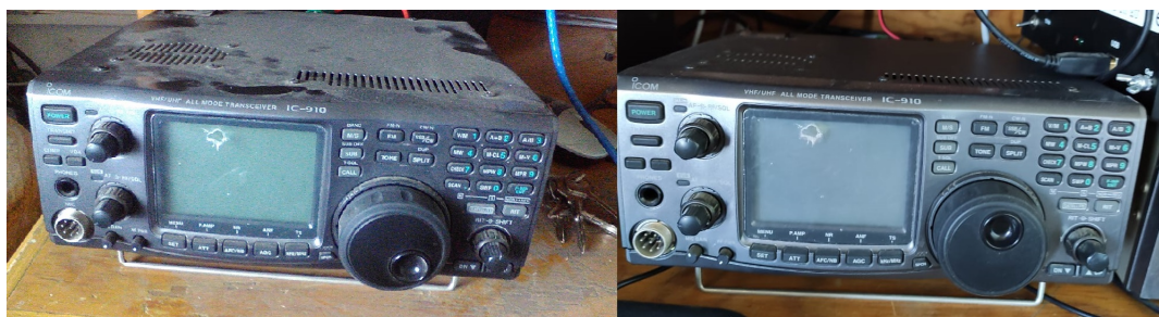
Figura 3.2: Radio transceptor ICOM 910-H. Antes y después de la limpieza
