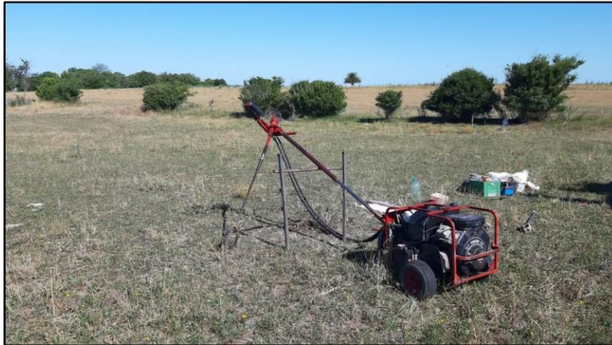
Figura 23: Perforadora Big Beaver-torre con comando hidráulico
