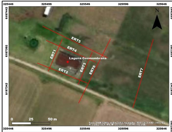
Figura 17: Transectos de ERT2D e IP2D en LG. Coordenadas en UTM 21S (m).
