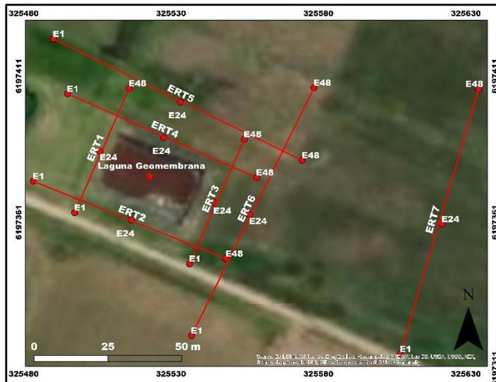
Figura 18: Electrodo de ERT2D e IP2D en LG. Coordenadas en UTM 21S (m).
