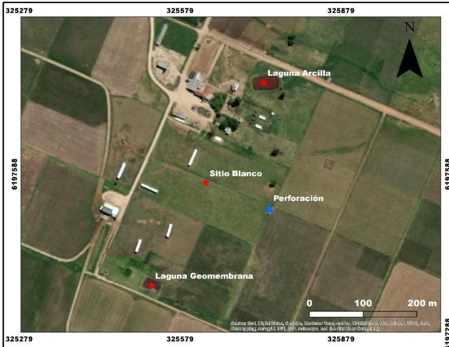
Figura 32: Perforación de abastecimiento de INIA y sitios de levantamiento geofísico. Coordenadas en UTM 21S (m).
