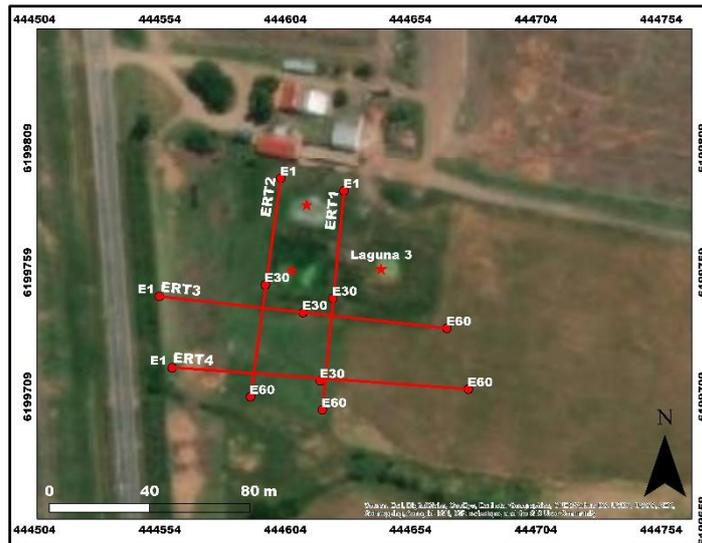
Figura 21: Electrodo de ERT2D e IP2D en lagunas en Sitio 2. Coordenadas en UTM 21S (m).
