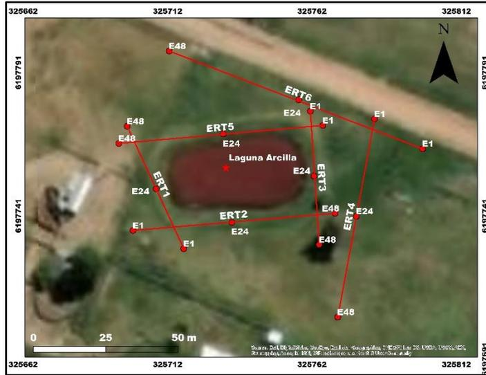
Figura 16: Electrodo de ERT2D e IP2D en LA. Coordenadas en UTM 21S (m).
