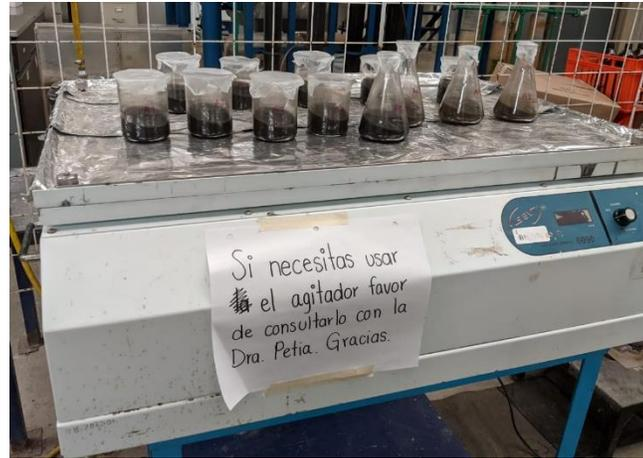
Figura 8. Pruebas preliminares de pretratamiento de lodo residual
