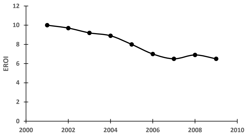
Figura II-9 EROI para la extracción de petróleo y gas en el campo Daqing entre 2001 y 2009. Adaptado de [126].
