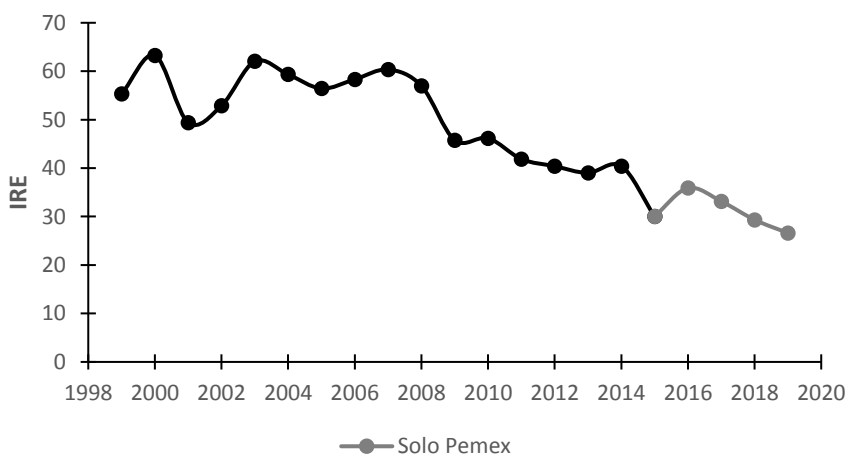
Figura IV-24 IRE para la extracción de petróleo y gas en México durante 1999-2019.
