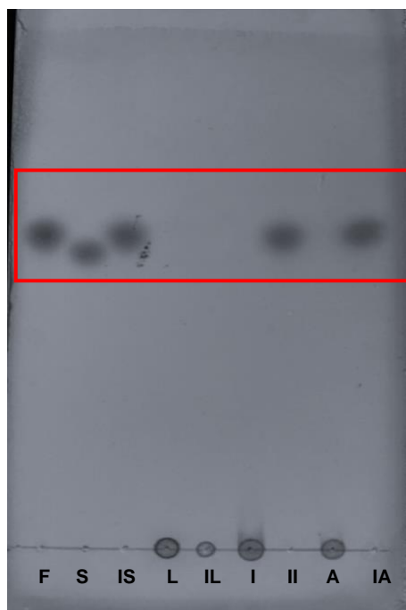
Fig 24. TLC de los productos de las reacciones entre el extracto crudo recombinante de inulinasa frente a los distintos sustratos a pH 8 por 20 min de reacción. Se observan las señales de fructosa al 1 % (F), sacarosa al 0.1 % (S), reacción entre el extracto crudo y sacarosa (IS), levana al 0.1 % (L), reacción entre el extracto crudo y levana (IL), inulina al 0.1 % (I), reacción entre el extracto crudo e inulina (II), agavina al 0.1 % (A) y reacción entre el extracto crudo y agavina (IA).
