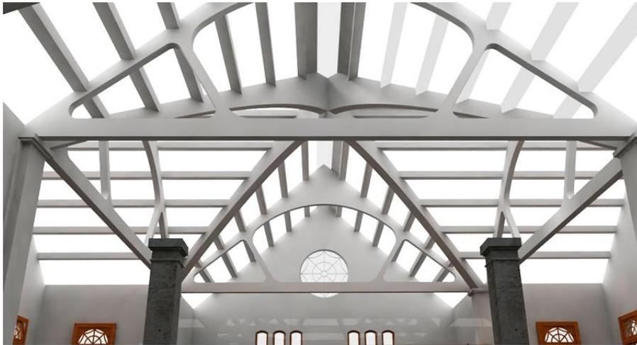
Fig. 22. Euroza, Rocio. *Vista interior sur de la Casa de Bombas no 3 Nativitas, modelado 3d.* Febrero de 2020. Se observaron las armaduras que conformaron los marcos rígidos de acero revestido en concreto.
