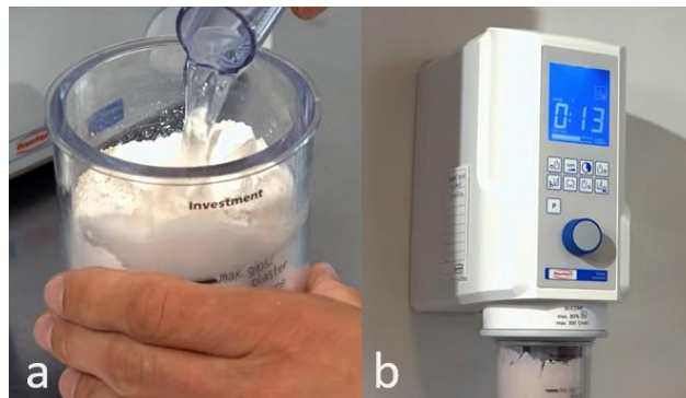
Figura 24. (a) Preparación de revestimiento, (b) mezclado al vacío. 29
