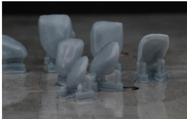
Figura 22. Carillas impresas en resina con impresora 3D. FD
