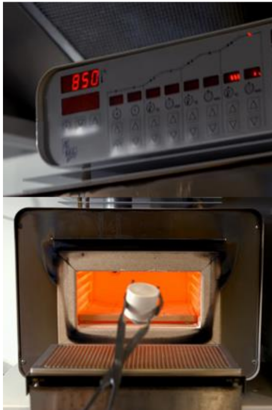
Figura 26. Desencerado del anillo de revestimiento a 850°C. 29
