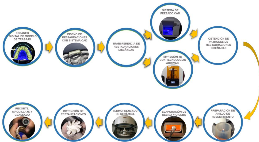
Figura 36. Flujo de trabajo en laboratorio dental para elaboración de restauraciones cerámicas.
