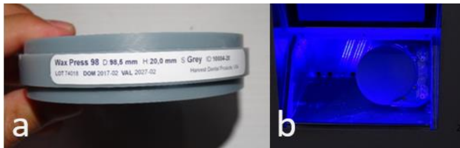
Figura 19. a) Disco de cera, b) colocación de disco de cera en sistema CAM. FD
