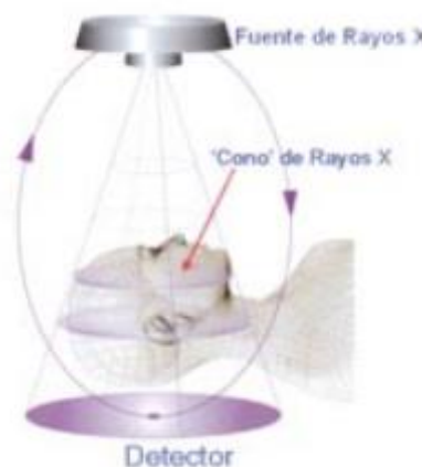
FIGURA 18. Esquema que muestra la adquisición de la imagen en la tomografía Cone Beam. (10 )
