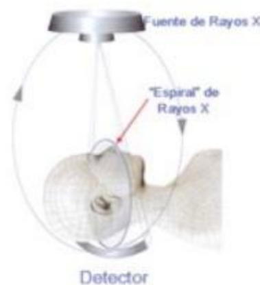
FIGURA 14. Esquema que muestra la adquisición de la imagen en tomografía computarizada. (10 )
