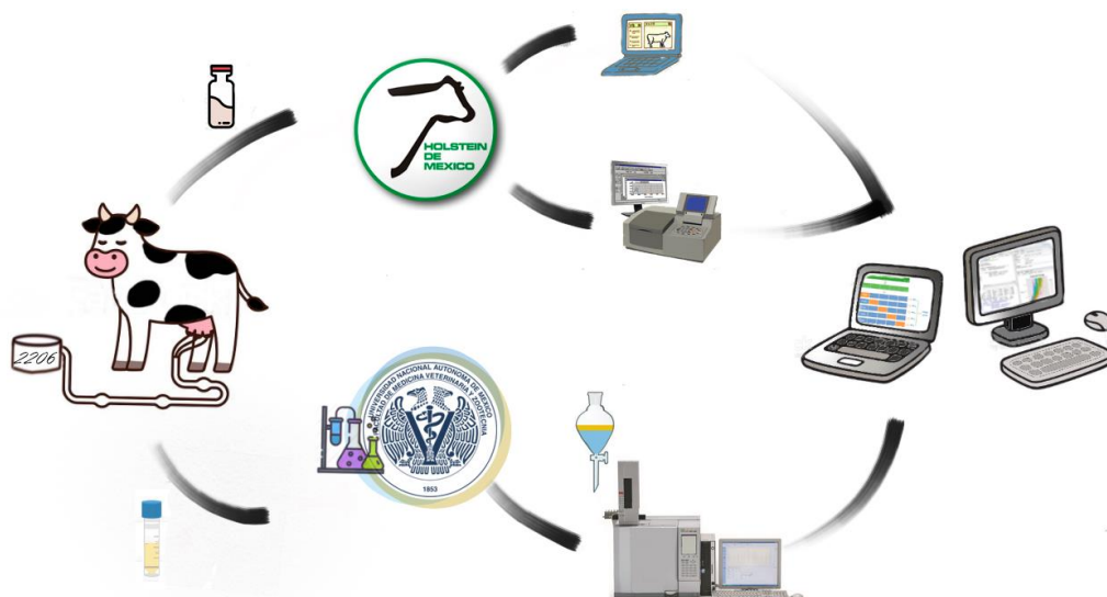
Figura 8. Proceso de toma de muestra, análisis y predicción del perfil detallado de ácidos grasos.
