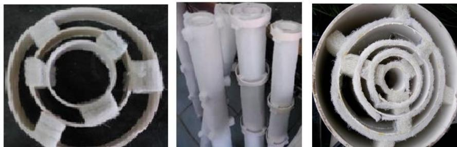
Figura 7. Estructura de los soportes empleados en el dispositivo experimental. A la derecha se observa el soporte dentro del reactor.
