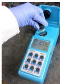
Figura 24. Determinaciones con Turbidímetro HANNA
