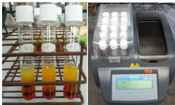
Figura 26. Determinación de DQO en digester HACH
