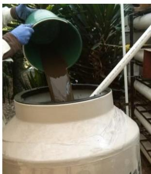
Figura 9. Inoculación del reactor con lodos de la PTAR-CU
