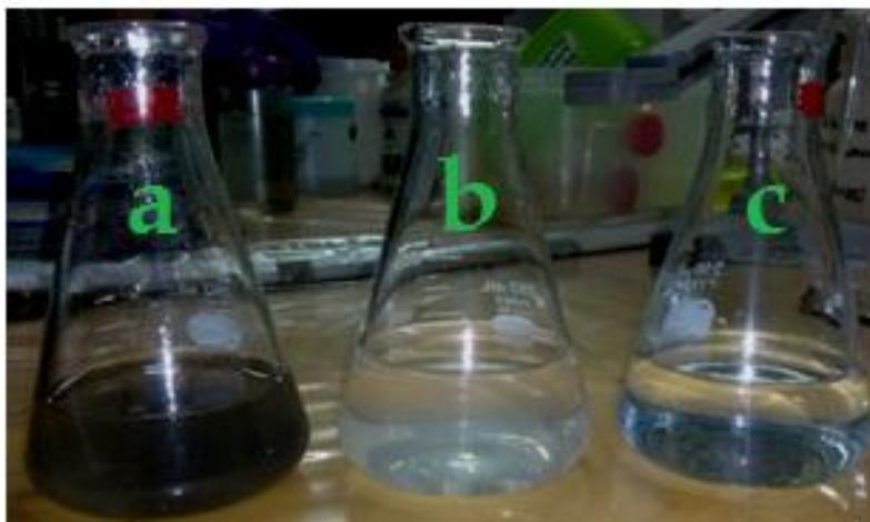
Figura 21. Comparación del aspecto del agua residual en cada etapa de tratamiento dentro del sistema experimental.
