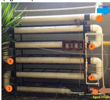
Figura 18. Puntos de muestreo de OD a lo largo del reactor tubular
