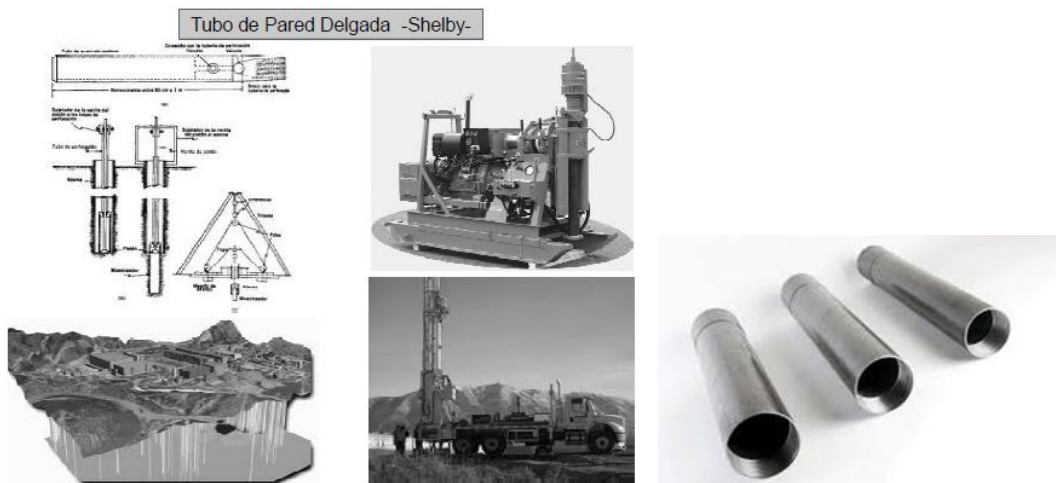
FIG. 14. EQUIPOS REQUERIDOS PARA REALIZAR EL HINCADO Y TUBO SHELBY
