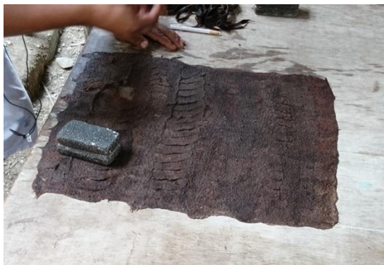
Figura 107b. La hoja de papel casi terminada. Sólo falta pulir su superficie, delimitar bien sus bordes y secarla al Sol. San Pablito, Pahuatlán, Puebla. Foto: OSD, 2018.
