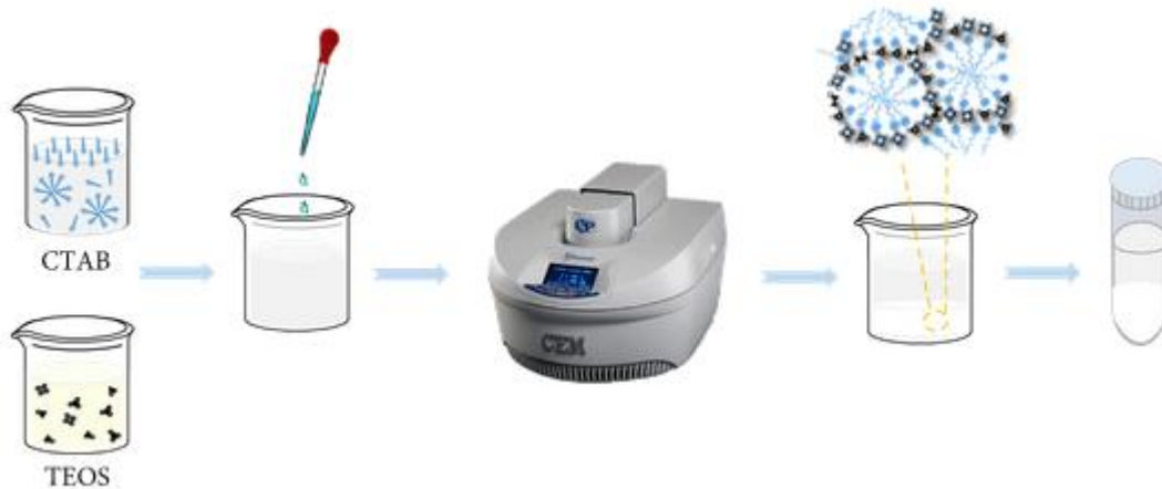
Figura 8. Esquema de síntesis por método de microondas. (Cheng et al., 2020)
