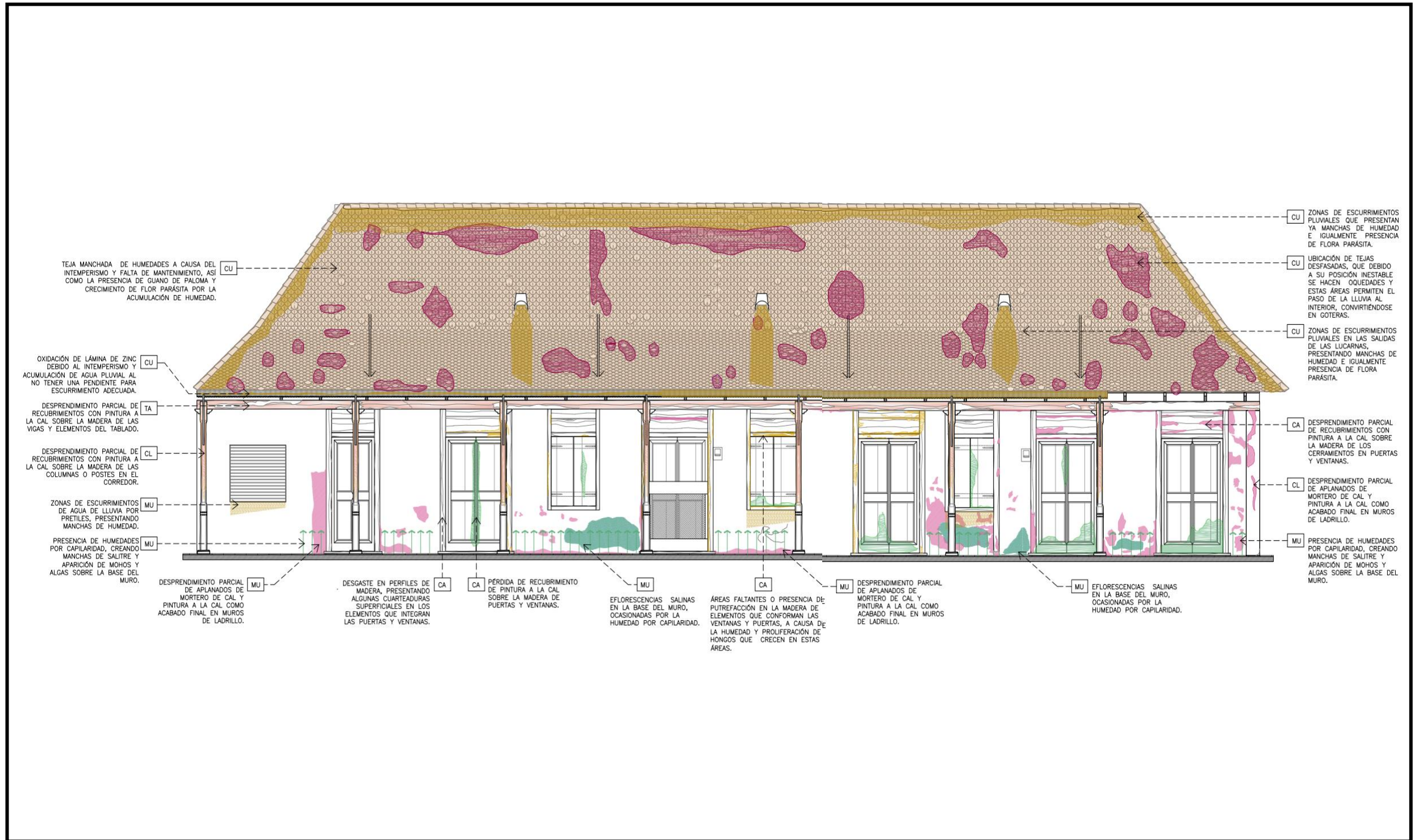
| 50 | Muestra de fachada de una vivienda de influencia francesa que fue tomada como caso de estudio para analizar e identificar los deterioros y daños más comunes en los materiales que integran a esta expresión arquitectónica. Plano elaborado por autora en febrero 2020.
