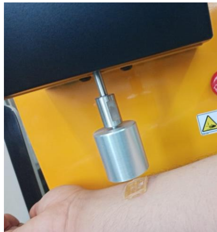
Figura 10. Acomodo de microaguja para prueba de bioadhesión y bioadhesión posthumectación
