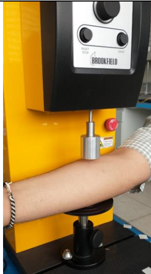
Figura 9. Montaje para la determinación bioadhesión y bioadhesión posthumectación
