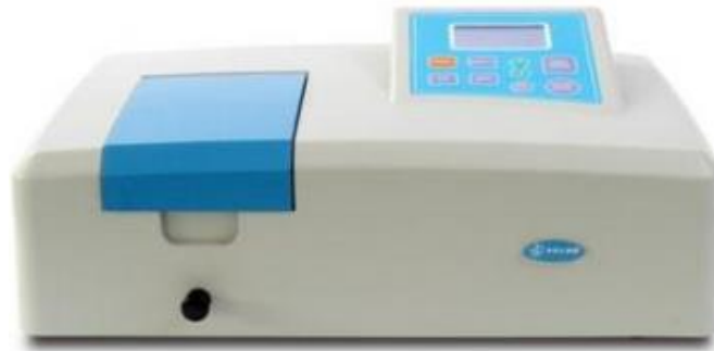
Figura 12. Espectrofotometro VelaQuin VE 5100UV empleado para las lecturas de las muestras de liberación
