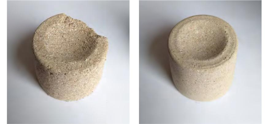
▲ Fig. 74. Fotografías propias de pruebas de tierra extraída del sitio, la primera sin agregados, la segunda con cal.
