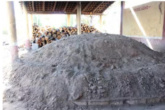
El horno se calienta con madera de la zona, durante la cocción se cubre con capas de bagazo, fibras, tierra y troncos.
