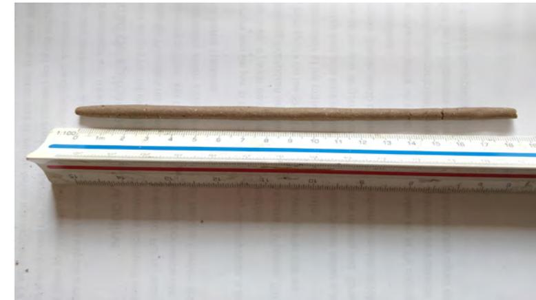
▲ Fig. 39. Fotografías propias del Test del cordón: Medición del largo de la cinta después de ruptura.
