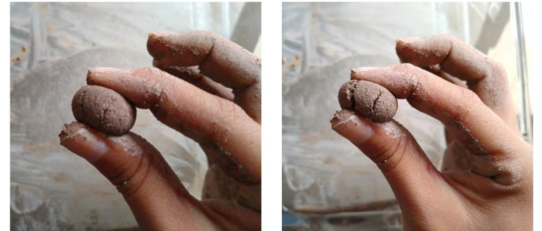
▲ Fig. 37. Fotografías propias del Test del cordón: Aplastamiento de la bola hasta ruptura.
