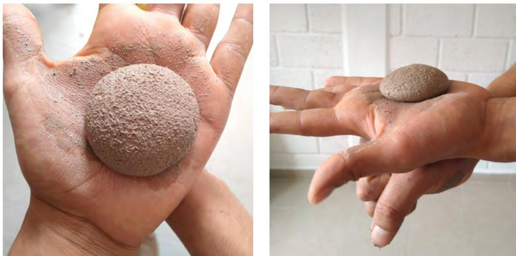
▲ Fig. 40. Fotografías propias del Test de exudación: Formación de la torta de tierra humedecida, y golpeo para que el agua salga a la superficie.
