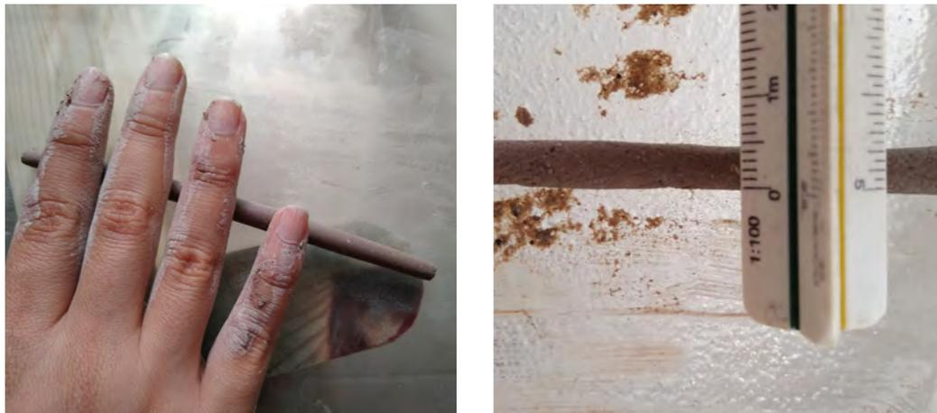
▲ Fig. 38. Fotografías propias del Test de la cinta: Formación de la cinta con 5 mm de diámetro.
