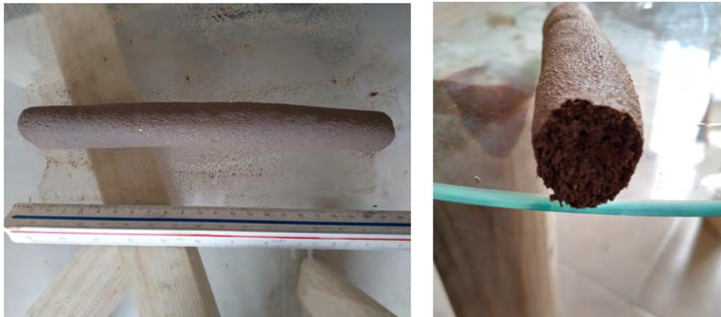
▲ Fig. 42. Fotografías propias del Test del rollo: Medición del rollo con las dimensiones especificadas, y trozo de rollo tras fractura.
