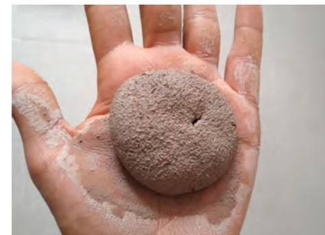
▲ Fig. 41. Fotografías propias del Test de exudación: Resultado de la muestra tras golpeo.
