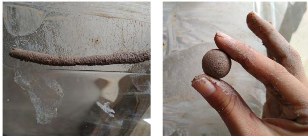
▲ Fig. 36. Fotografías propias del Test del cordón: Formación del cordón hasta que alcanza los 3 mm de diámetro antes de romperse, y formación de bola.
