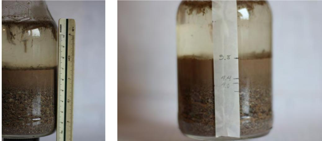
▲ Fig. 33. Fotografías propias del Test del vidrio: Se observa la sedimentación de la muestra de tierra del sitio dentro de un frasco de vidrio, con las alturas por capa.
