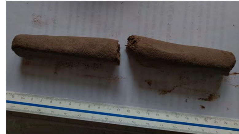
▲ Fig. 42. Fotografías propias del Test del rollo: Medición de los fragmentos tras ruptura.
