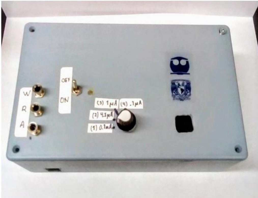
Figura 18. Foto del potenciostato en su versión final, soldado en placas PCB y en un gabinete de plástico.
