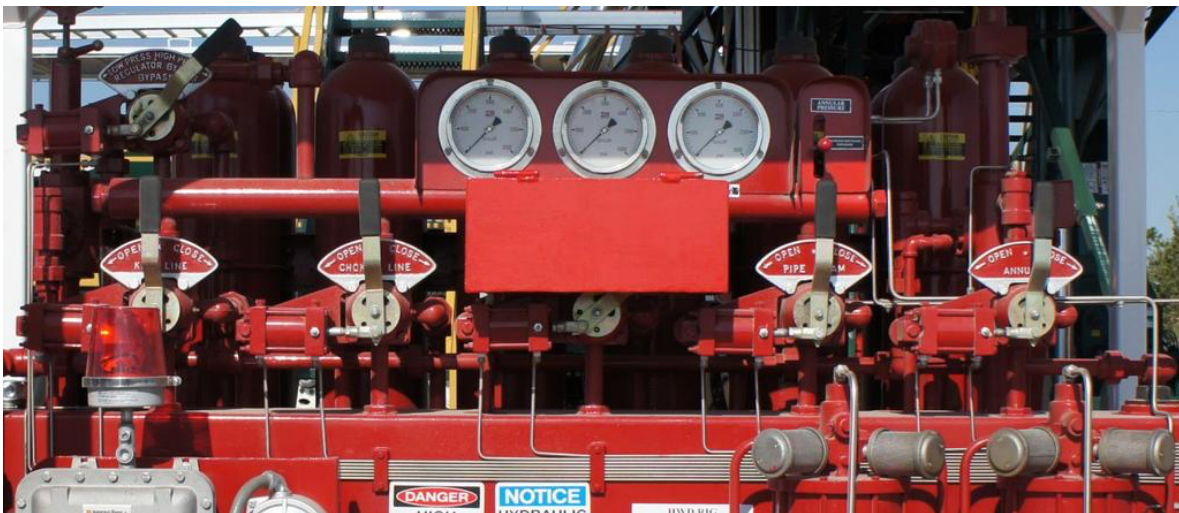
Figura 23. Unidad acumuladora de presión (obtenido de Procedimiento Operativo estándar - Unidad Koomey (acumulador) cuando no esté en uso, Horizontal Well Drillers, 2012)
