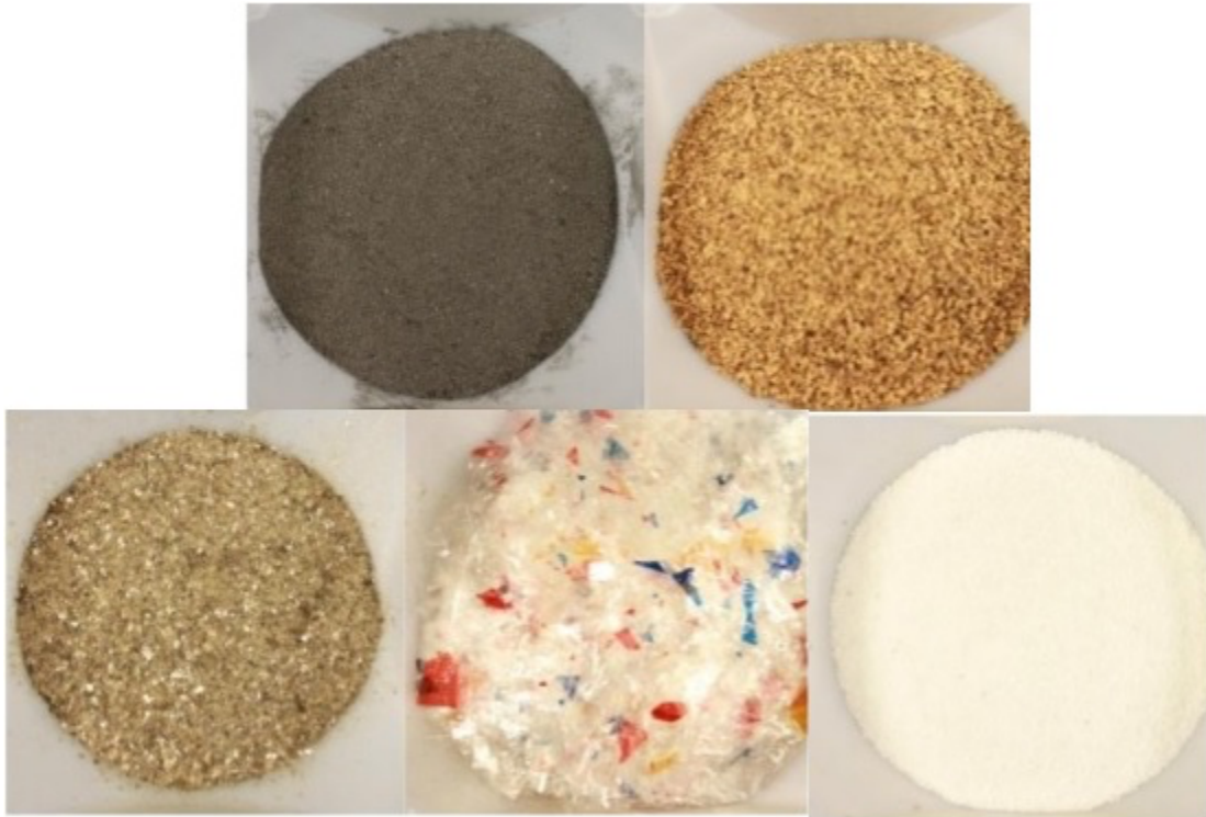
Figura 34. Ejemplos de LCM: 1 – Grafito, 2 – Cascarás de nuez, 3 – Mica, 4 – Celofán, 5 – Carbonato de calcio (modificado de Alsaba, M. et al., 2014)
