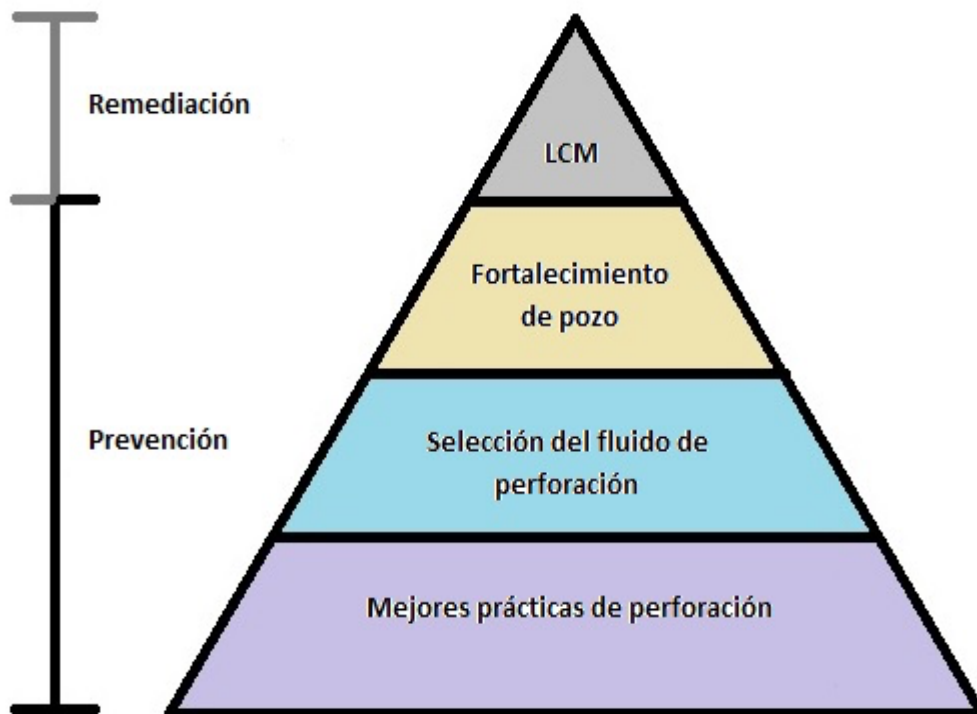
Figura 21. Programa para el manejo de los escenarios de pérdida de circulación (modificado de Cook, J. et al., 2012)
