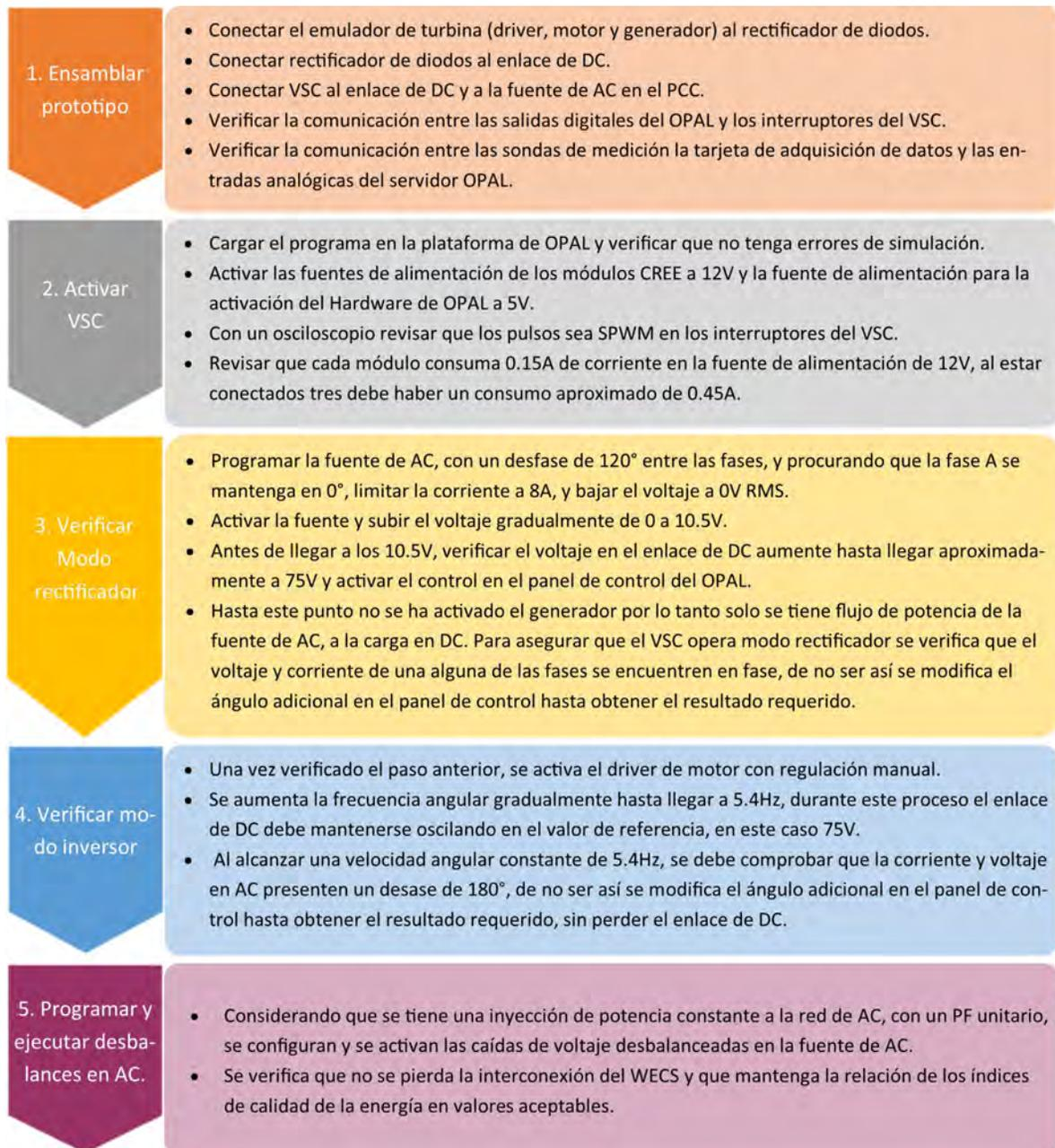
Figura 5.7: Secuencia para activar prototipo del WECS de baja escala.
