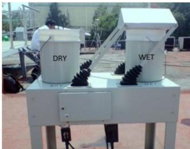
**Figura 18.** Sistema de muestreo del depósito atmosférico, marca Aerochem Metrics, Modelo 301.
