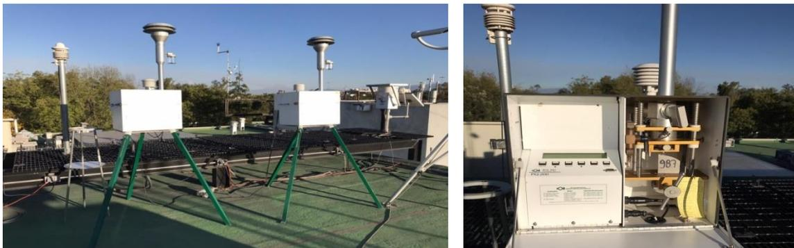
**Figura 10.** Muestreadores BGI en la estación del CCA, UNAM
