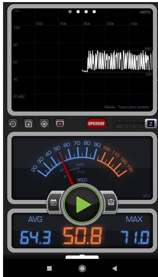
Figura 40. Medición de sonido de salida de audio con “Decibel X”.
