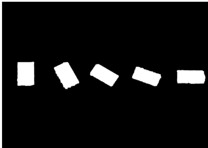
Figura 4-22: Eliminación de ruido excedente en figuras cerradas y alrededor del escenario a través de Opening con kernel de 13x13
