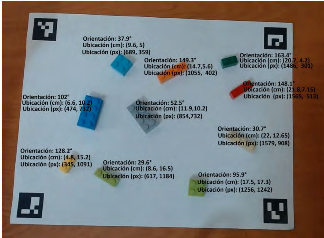
Figura 5-1: Posición de los legos en centímetros y su relativo en pixeles. El ancho y alto del escenario es de 26.75cm y 20.5 cm respectivamente; y sus dimensiones relativas en pixeles serían 1920 px y 1471 px
