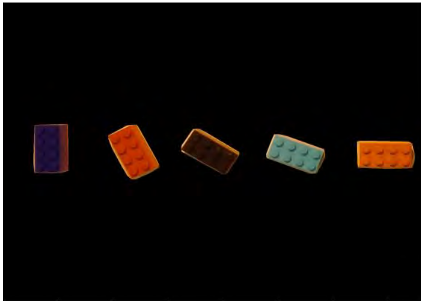
Figura 4-24: Resultado de la imagen segmentada a través de la máscara de segmentación de 4-23 y la imagen corregida de 4-16
