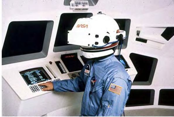
Figura 2-20: Virtual Visual Environment Display o VIVED desarrollado por la Nasa. Imagen extraída en Noviembre 2021 de: https://www.engadget.com/2013-12-15-time-machines.html
