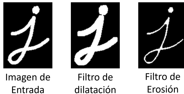
Figura 2-10: Ejemplo de operaciones de filtros morfológicos. Recuperada en octubre 2021 de: https://opencv24-python-tutorials.readthedocs.io/en/latest/py_tutorials/py_imgproc/py_morphological_ops/py_morphological_ops.html
