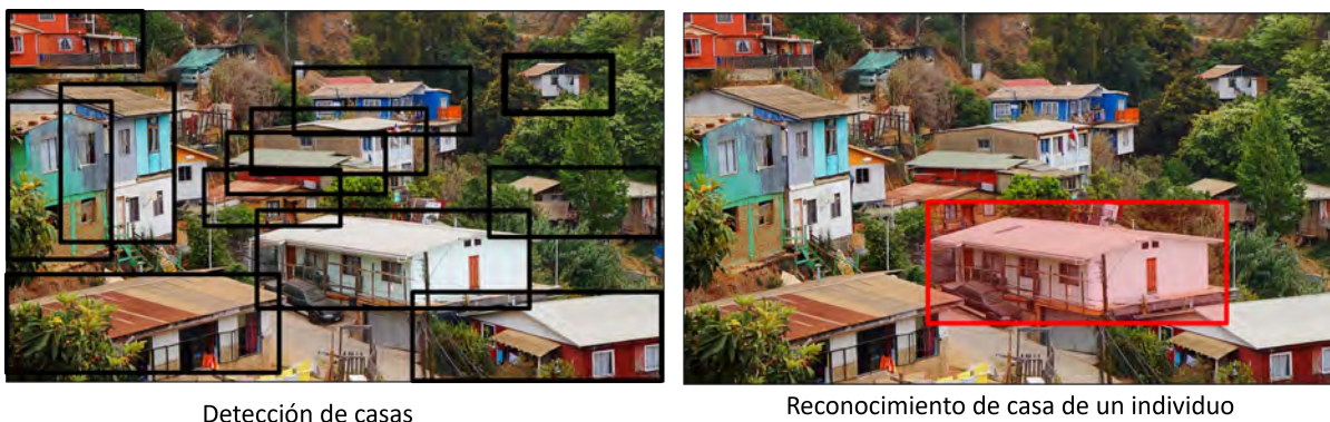
Figura 2-14: Diferencia entre detección de objetos y reconocimiento de instancias. Imagen extraída en octubre 2021 de: https://www.pxfuel.com/es/free-photo-xwhrj
