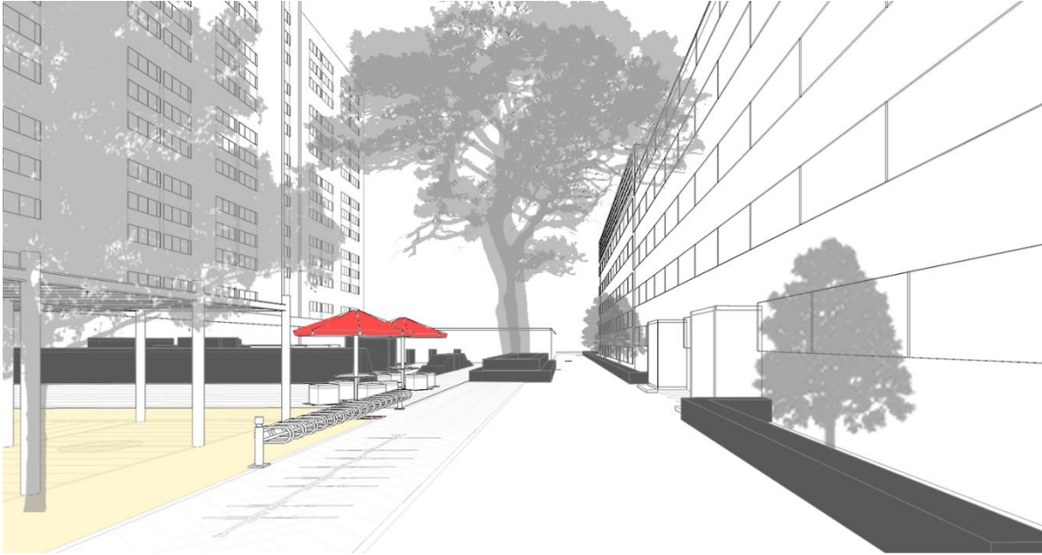
Figura 71 | Elaboración propia. (2021). Modelado de propuesta de intervención. [Gráfico]. Vista perspectivada de senda con conexión a las entradas de los edificios y la plaza, se eliminaron los rajueados y se amplió el área de circulación, de la misma manera se propuso que las vistas fueran más perspectivada y legibles, se adecuo un estacionamiento para bicicletas y se redujeron las dimensiones de las jardineras.
