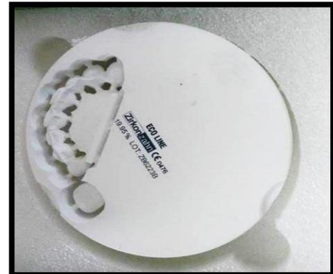
Figura 14 y 15. Fresado de disco de zirconia a la izquierda, restauración fresada a la derecha.<sup>22</sup>
