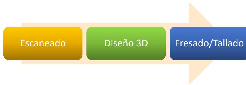
Figura 9. Flujo de trabajo CAD-CAM.<sup>26</sup>
