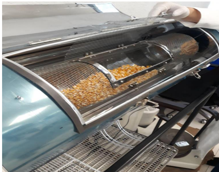
Figura 3. Prototipo de radiación con luz UV-C empleado para la radiación de grano de maíz amarillo.
