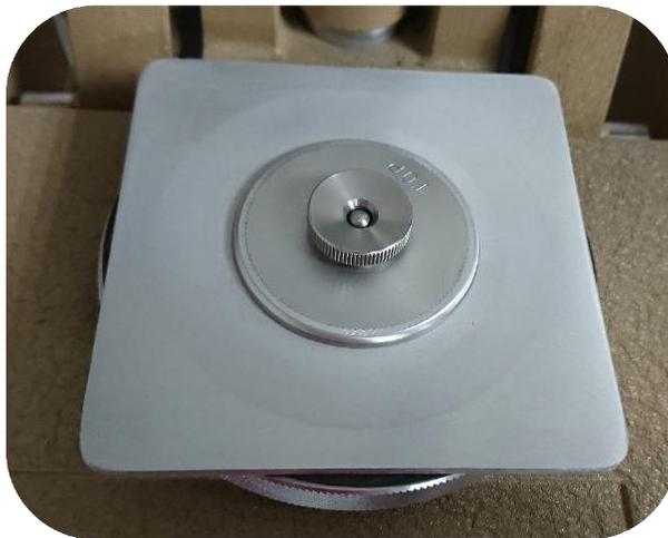
*Figura 15. Placa de Al7075-T6 recubierta con HPSRF y montada sobre el Taber.*
