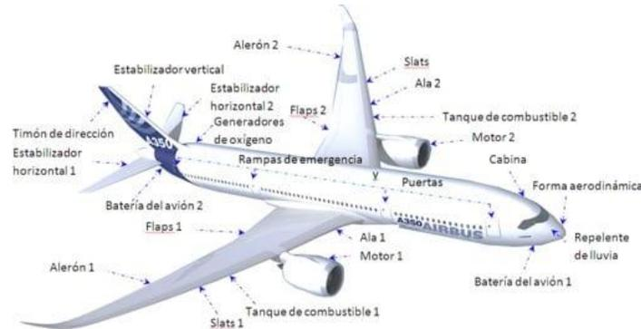
Figura 2. El avión de transporte y sus principales secciones estructurales.
