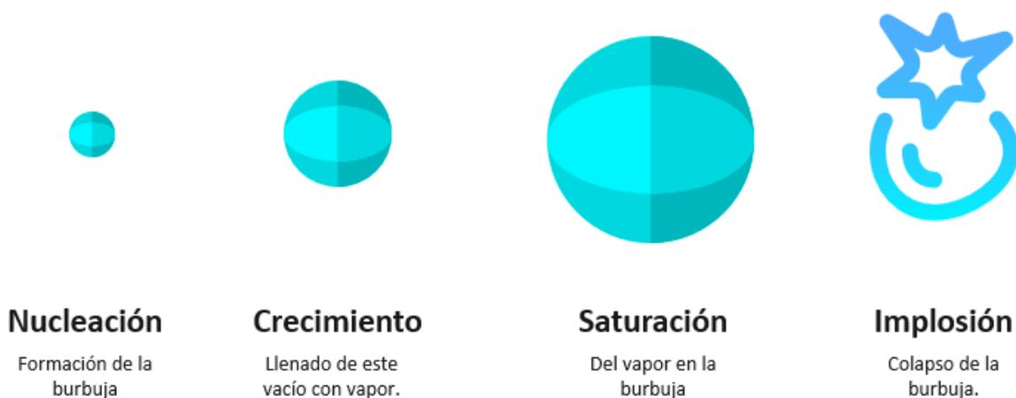
Figura 6. Cavitación inducida por ultrasonido.
