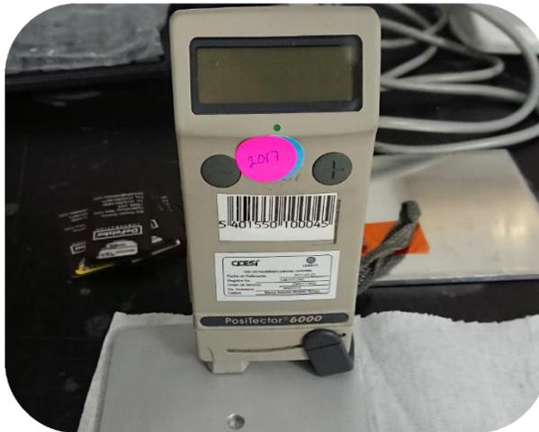
Figura 23. Medidor de espesores Positector 6000.
