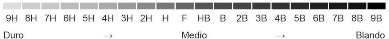
Figura 11. Escala de durezas.
