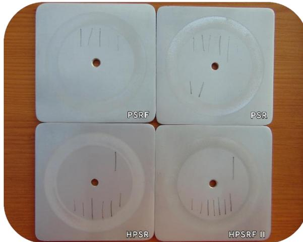
Figura 24. Ensayo de dureza al lápiz sobre placas de Al7075-T6 recubiertas con PSRF, PSR, HPSR y HPSRF.
