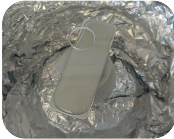
*Figura 20. Placa de Al7075-T6 cubierta del nanohíbrido y montada sobre el spin coating.*
