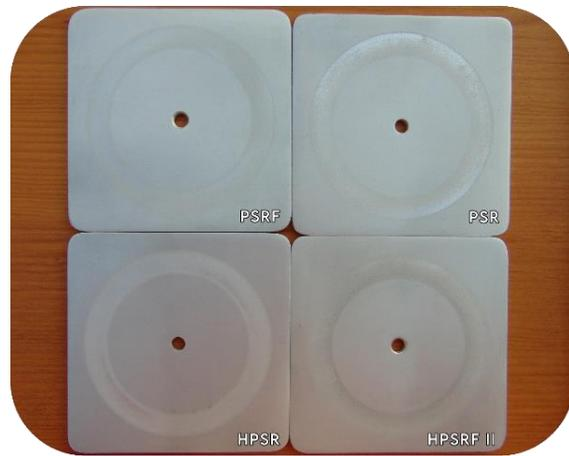
*Figura 25. Resistencia a la abrasión de los recubrimientos PSR, PSRF, HPSR y HPSRF.*
