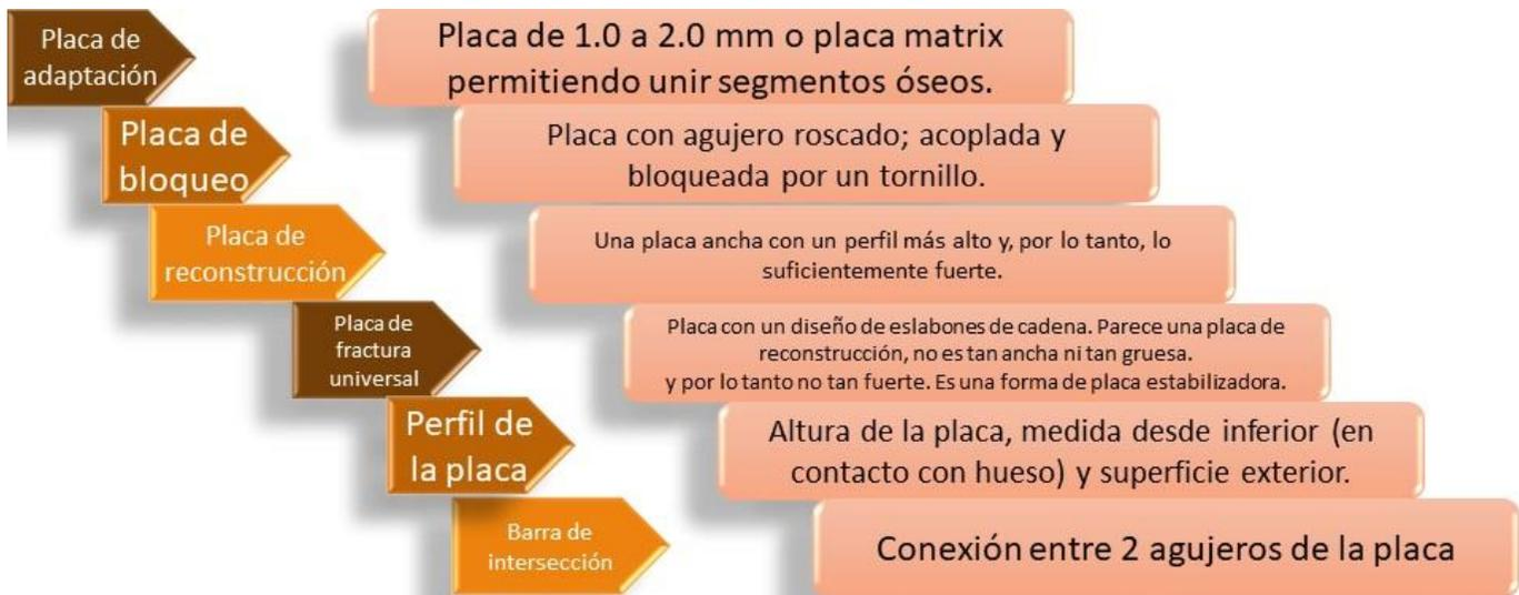
Fig. 38 partes y tipos de placas, definiciones. Elaboración propia <sup>38</sup>
