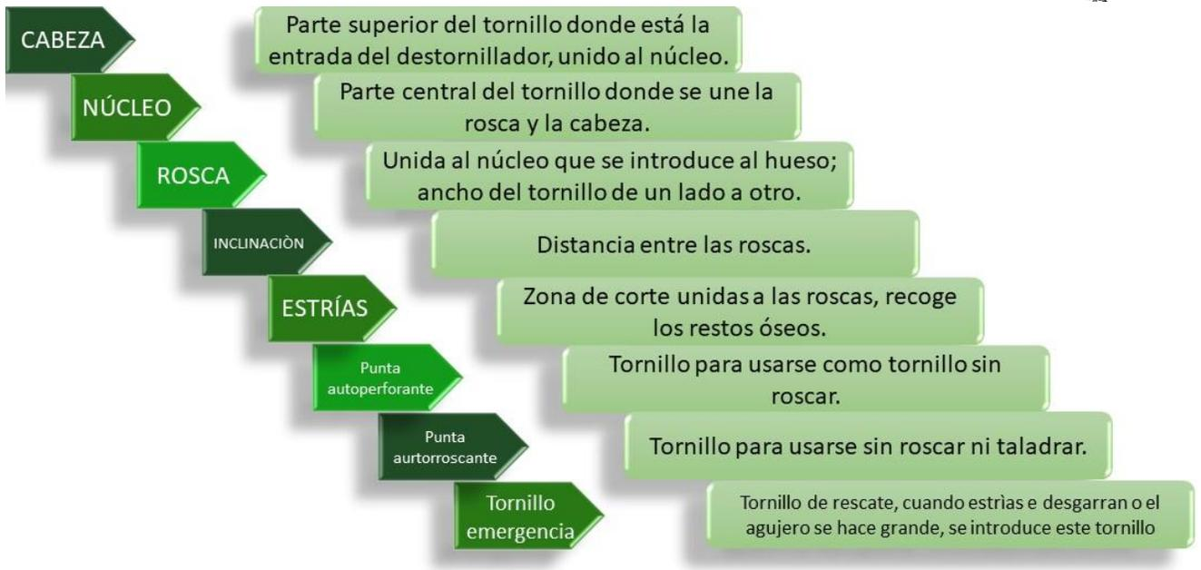
Fig. 46 Partes del tornillo y los diferentes tipos de cabeza que tienen <sup>38</sup>. Elaboración propia.
