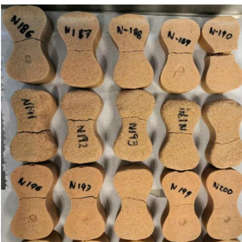
Figura 20. Noyos de arena después del ensayo a la tracción.
