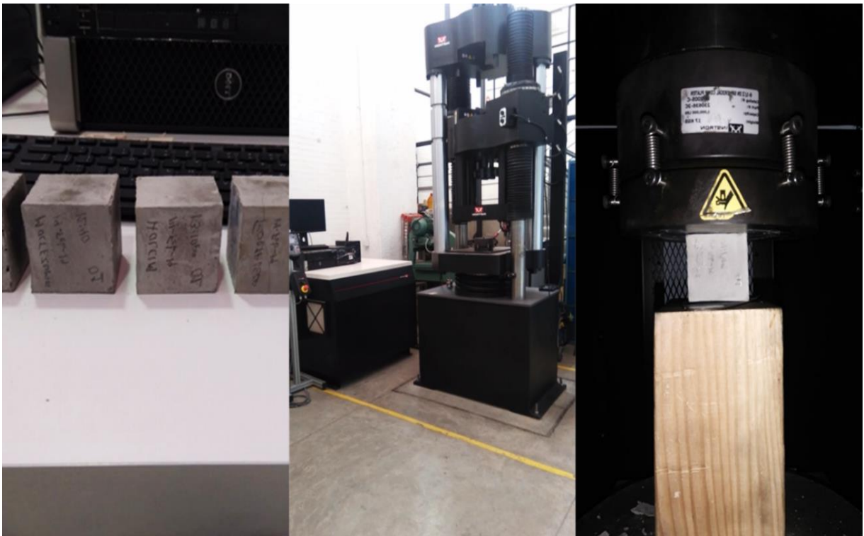
Imagen 31. Prueba de compresión en cubos de mortero, ASTM-C-109. LMSE. (2019)
