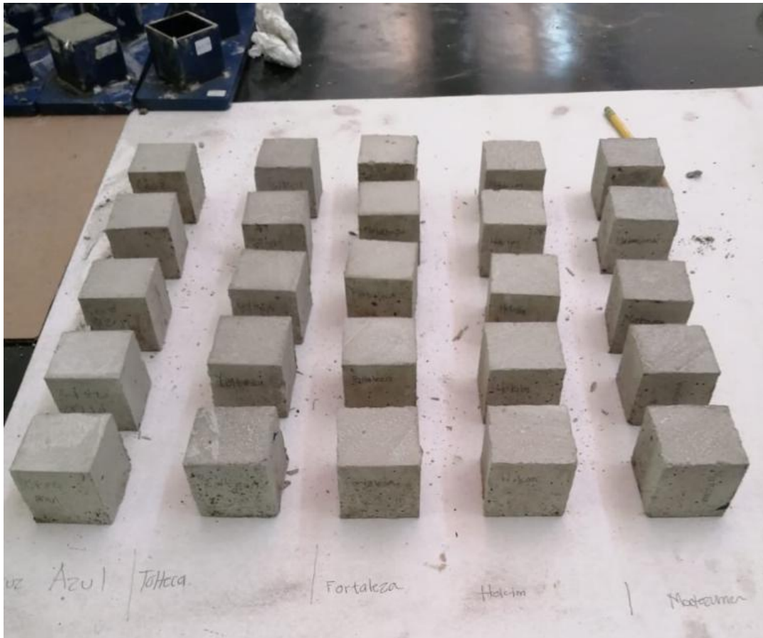
Imagen 30. Probetas de mortero cubicas de 5 cm clasificadas previamente a ser ensayadas. LMSE UNAM (2019)
