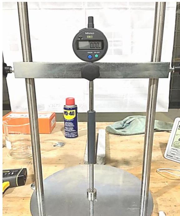
Imagen 9. Colocación de varilla para calibración del comparador longitudinal, marca Mitutoyo, LMSE (2019)
