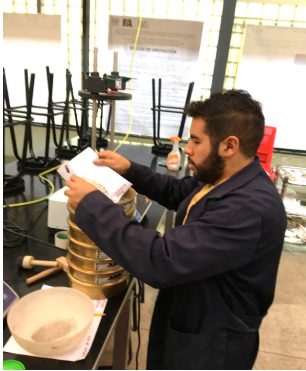
Imagen 24. Vaciado del agregado en los tamices LMSE, UNAM (2019)
