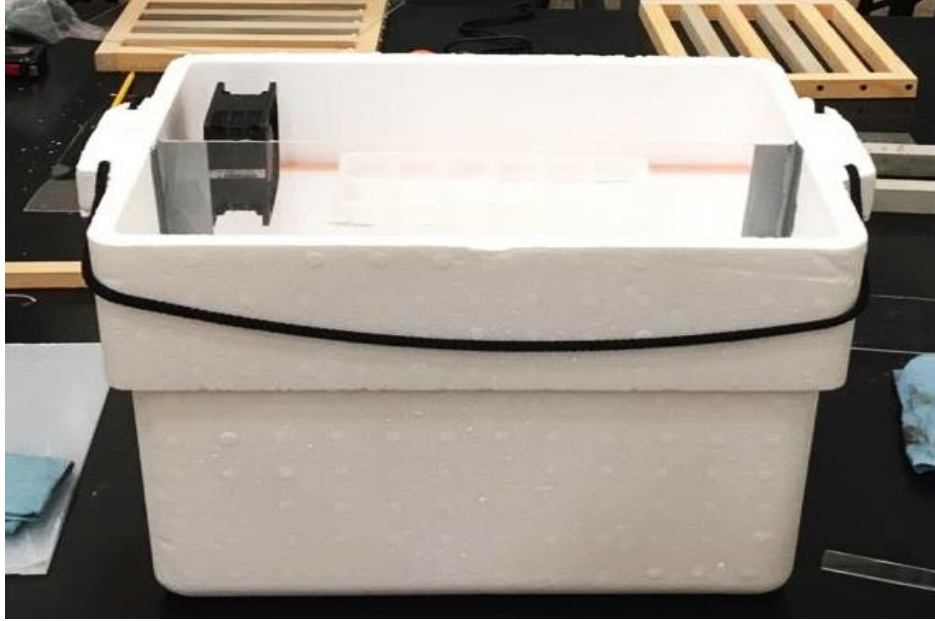
Imagen 11. Cámara prefabricada de húmeda para curado. C. Carbajal (2019)
