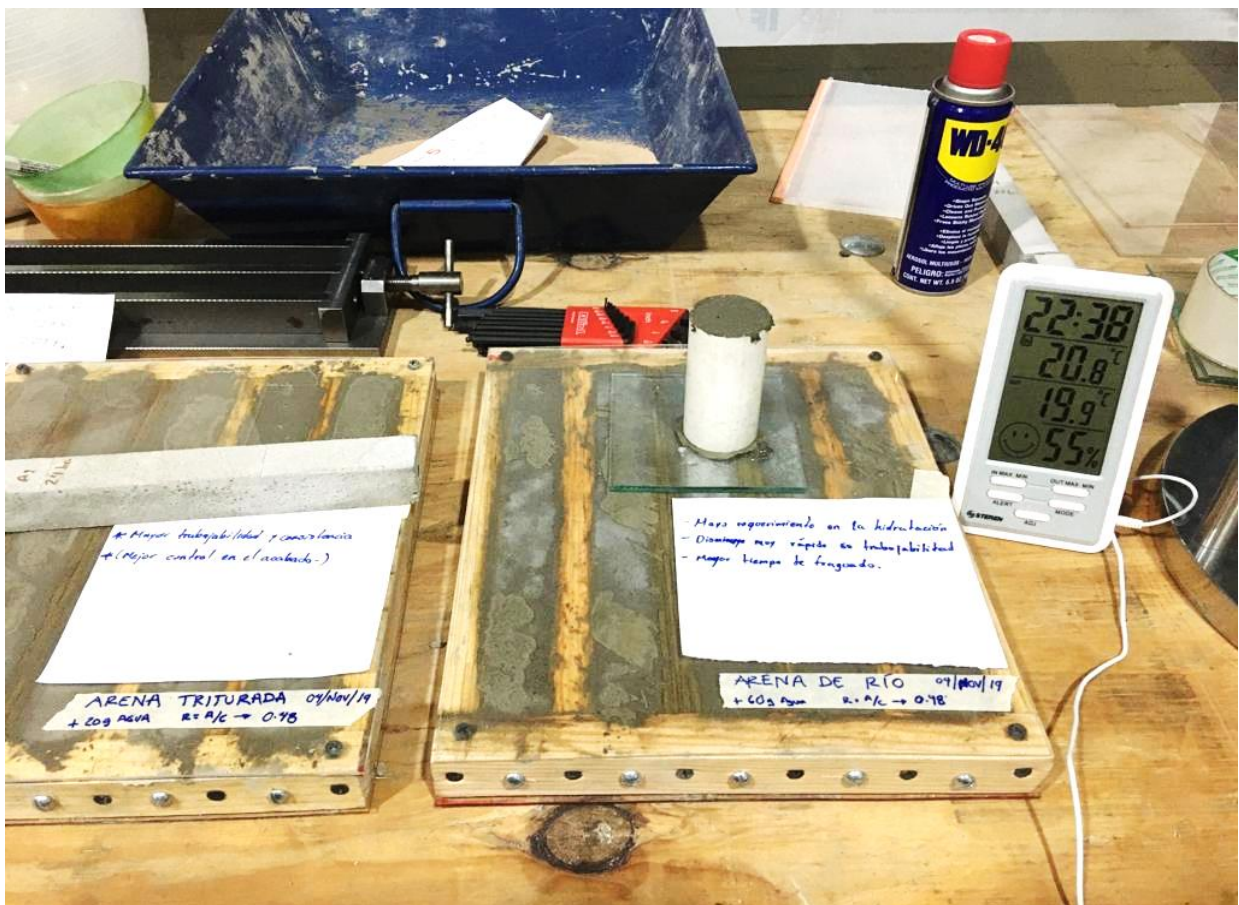
Imagen 13. Elaboración de muestras prismáticas, de acuerdo con la norma ASTM-C-151
