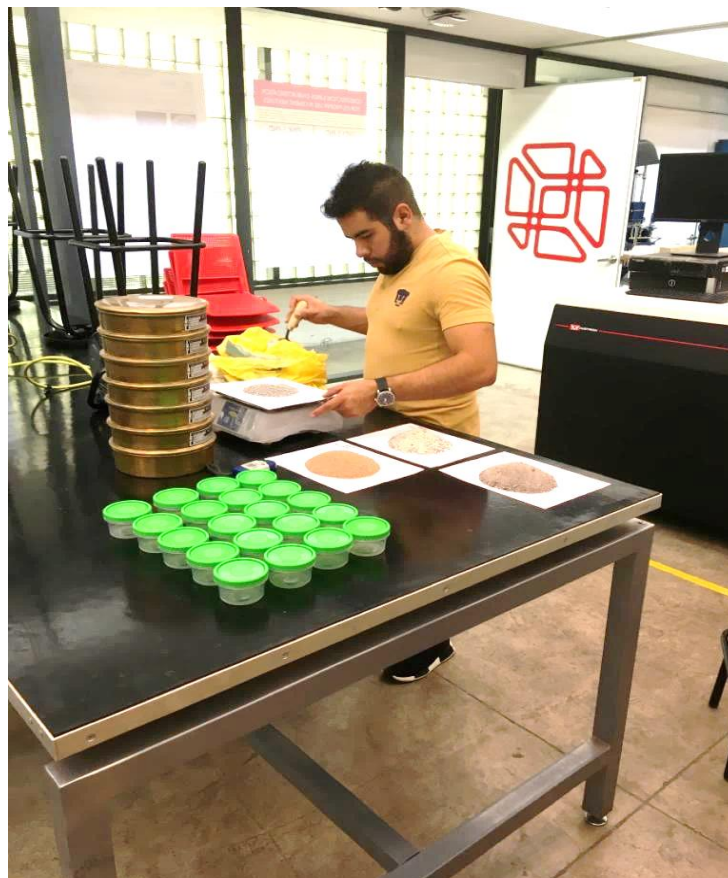
Imagen 23. Proceso de tamizado en los cuatro tipos de agregados evaluados; Arena sílica, arena azul, arena triturada y arena de río. LMSE (2019).
