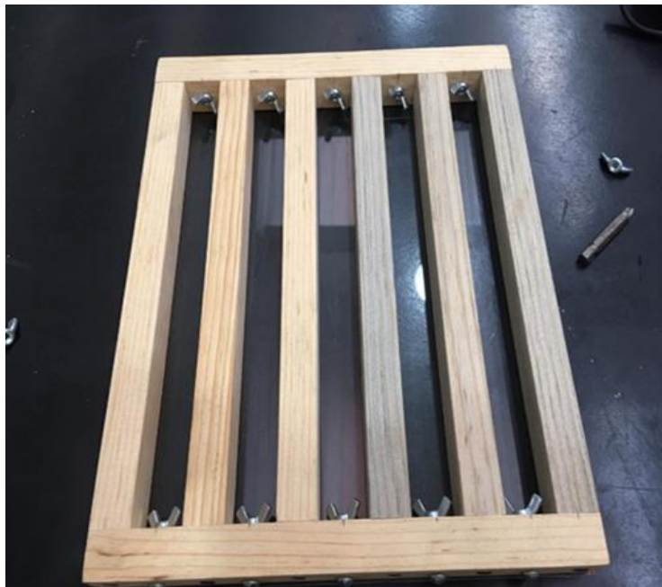
Imagen 8. Molde de madera para probeta prismática, ASTM-C-151 LMSE, UNAM (2019)
