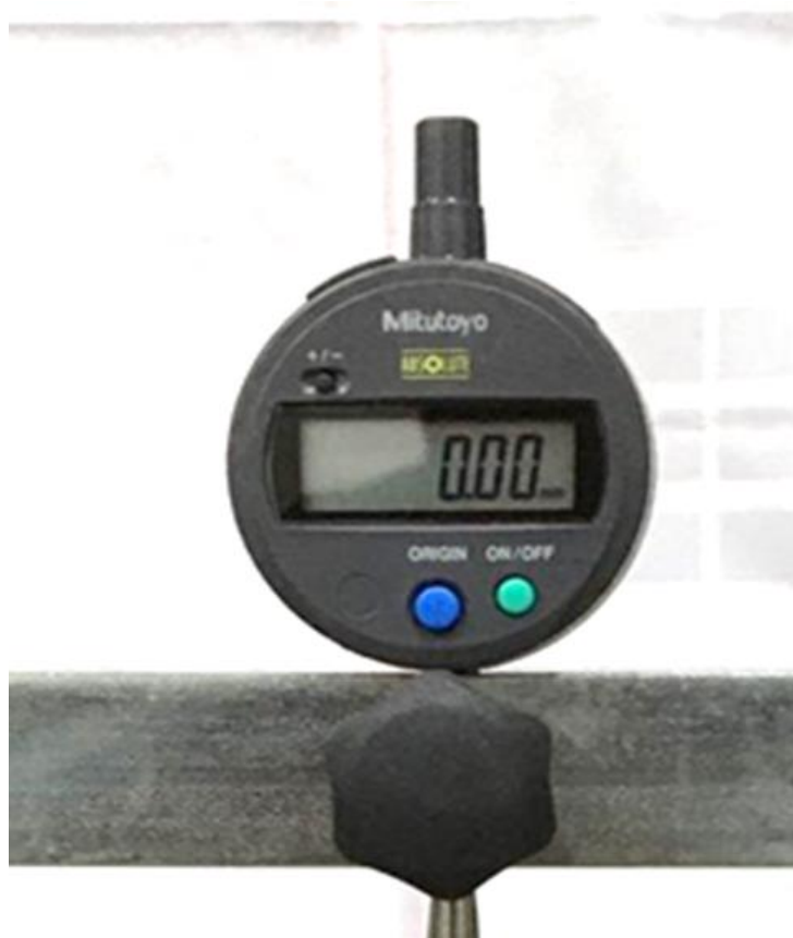
Imagen 10. Calibración del comparador longitudinal, Mitutoyo, LMSE (2019)
