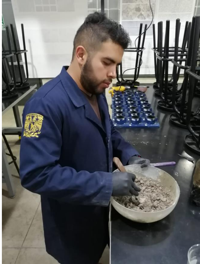
Imagen 20. Elaboración de cubos de 5 x 5 cm de acuerdo con la norma ASTM-C-109, para prueba de compresión. (2019)
