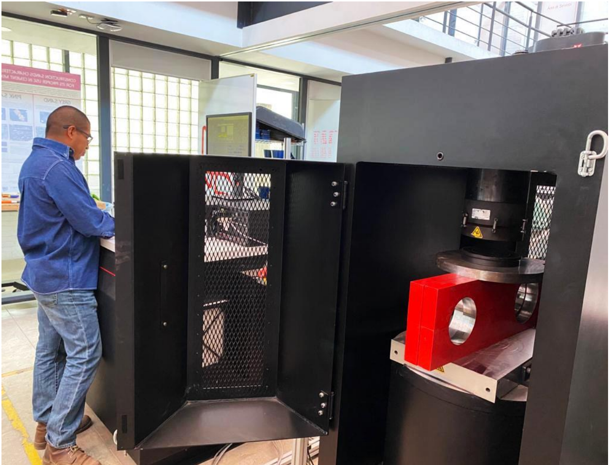
Imagen 22. Técnico de Laboratorio de Materiales y Sistemas Estructurales Calibrando equipo Instron para evaluar las pruebas a compresión, UNAM (2020)
