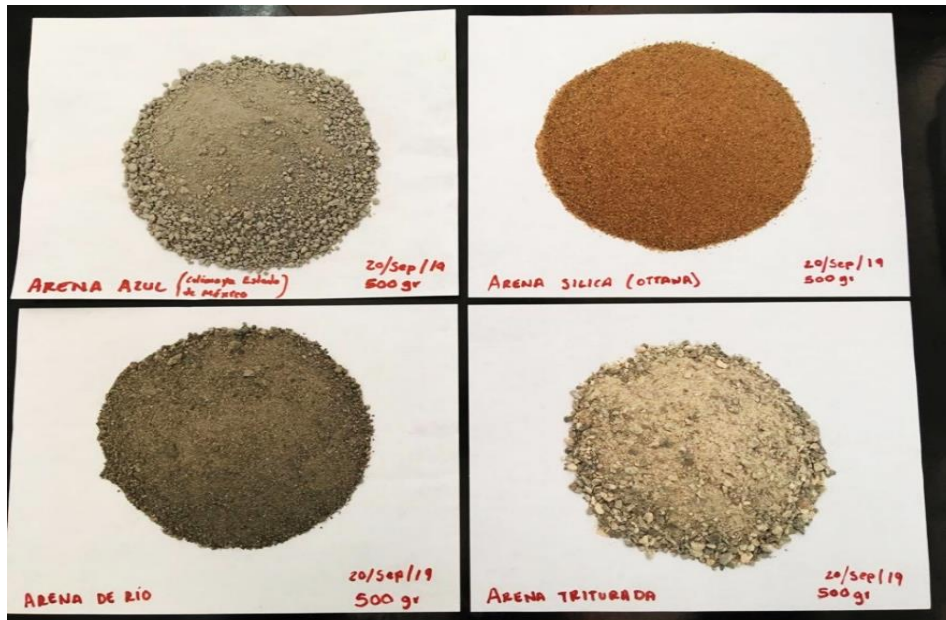
Imagen 3. Arena azul, arena sílica, arena de río y arena triturada. (2019)
