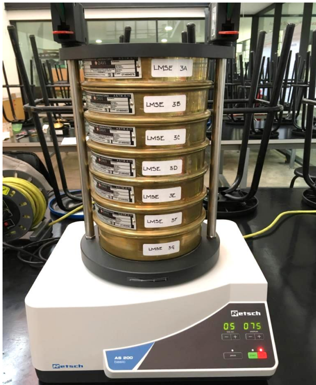
Imagen 25. Tamizadora Retsch, Mod AS200, LMSE UNAM (2019)
