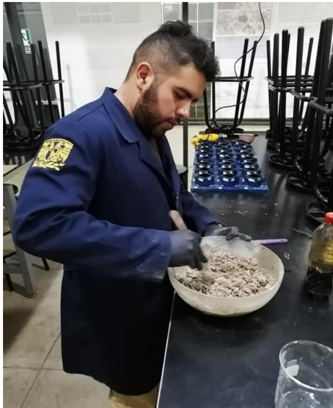
Imagen 5. Proceso de mezclado de mortero, LMSE, UNAM (2019)
