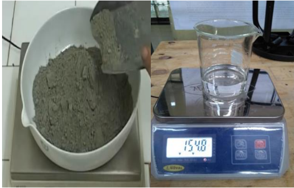
Imagen 14. Pesaje de cemento Portland tipo II CPC 30 R LMSE, UNAM (2019)
