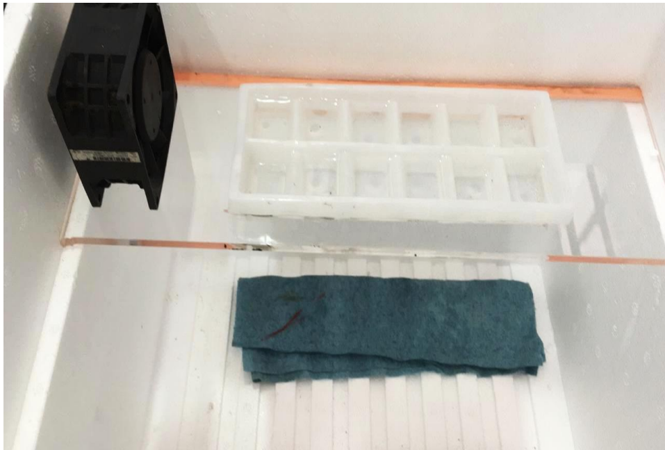
Imagen 12. Sistema generador de humedad interior. C. Carbajal, LMSE (2019)
