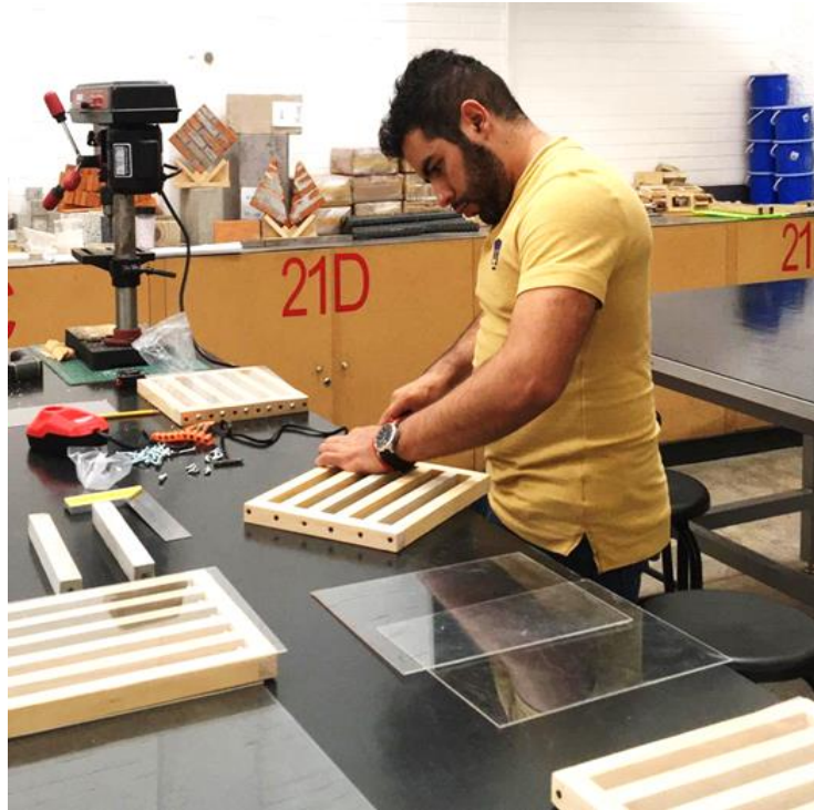
Imagen 7.. Proceso de elaboración de moldes, norma ASTM-C-151 LMSE, UNAM (2019)
