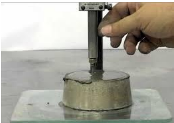
Imagen 16. Proceso de penetración en la mezcla de mortero LMSE, UNAM (2019)
