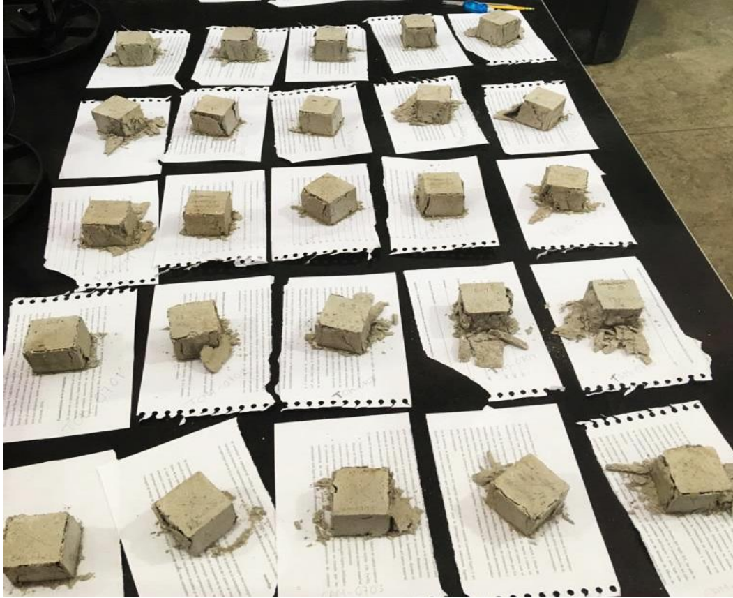
Imagen 32. Muestras destructivas en cubos de mortero de 5 cm x 5 cm, C. Carbajal, LMSE (2019)
